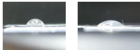
図(1)-30 PPフィルムの水ぬれ性 (a)未処理、(b)プラズマ処理
