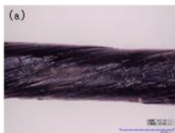
図(6)-22 CNT 繊維(a)CNT 繊維太陽電池試料 NO.3(b)の光学顕微鏡像と CNT 繊維太陽電池 NO.4(c)の 反射電子像
