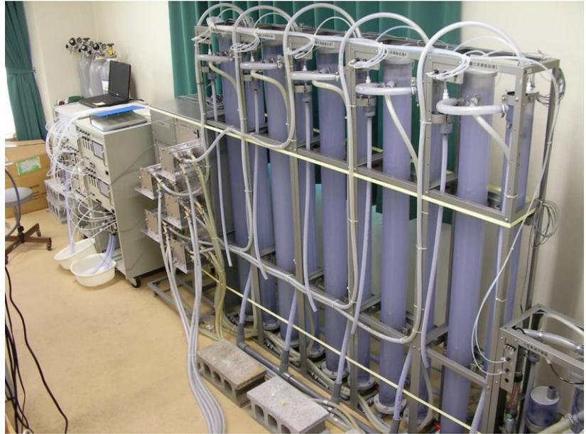
図4 CO<sub>2</sub>分圧制御飼育装置の設置写真。
