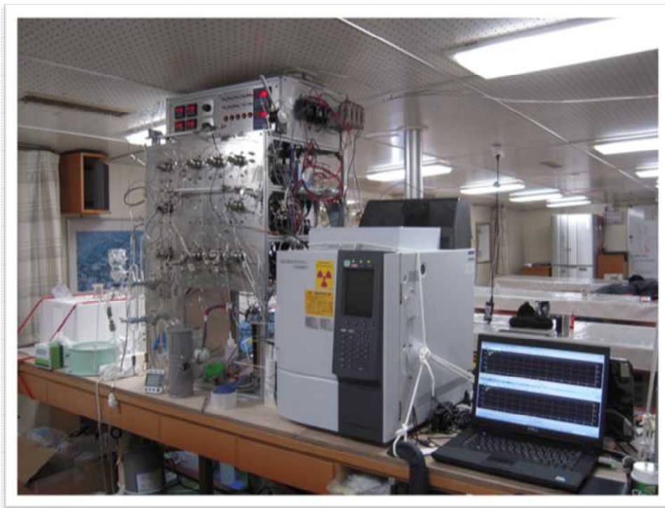
写真 1：本研究で開発された溶存ハロゲン化合物の多成分同時定量装置の外観（2011年6月実施の北海道大学おしよ丸第229次航海において、一般居住室（学生食堂の一角）に設置したときに撮影）
