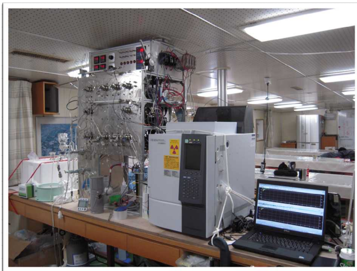
写真(3)-1 本研究で開発された溶存ハロゲン化合物の多成分同時定量装置の外観（2011年6月に実施された北海道大学おしよろ丸第229次航海において、一般居住室（学生食堂の一角）に設置したときに撮影）
