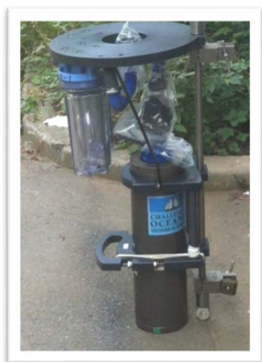
写真(2)-1 現場海水濾過装置
