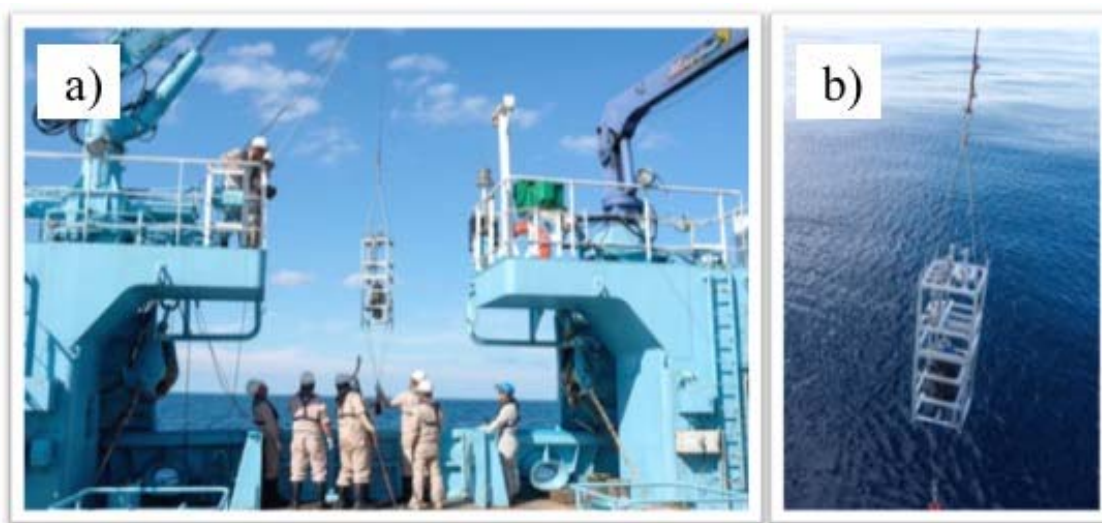
写真(2)-3 POPs現場濾過装置の動作確認試験（2014年10月、長崎丸船上）
