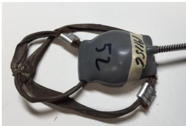
図(3)-5 ハーネスの交点は木綿糸で縫い合わせ、糸の劣化によって発信機が脱落する
