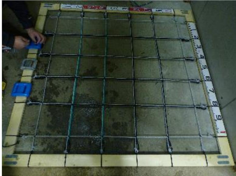
図(3)-7 木枠で作成した擬似金庫網口
