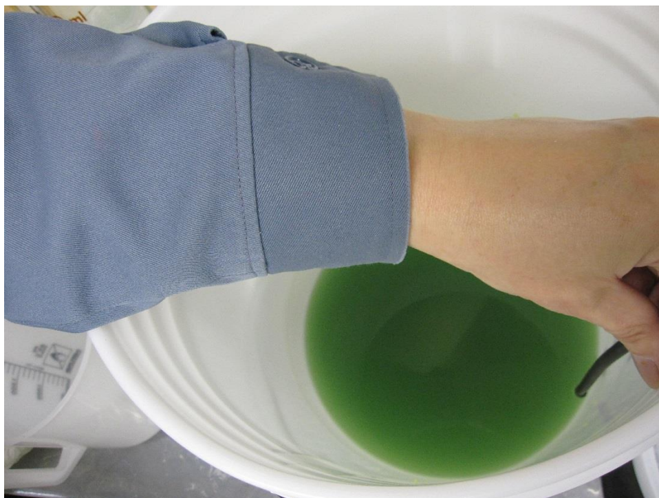
図 4-3-4-3 再洗浄済み吸着剤を用いた固液分離 (吸着処理槽から上澄みを吸い取る)
