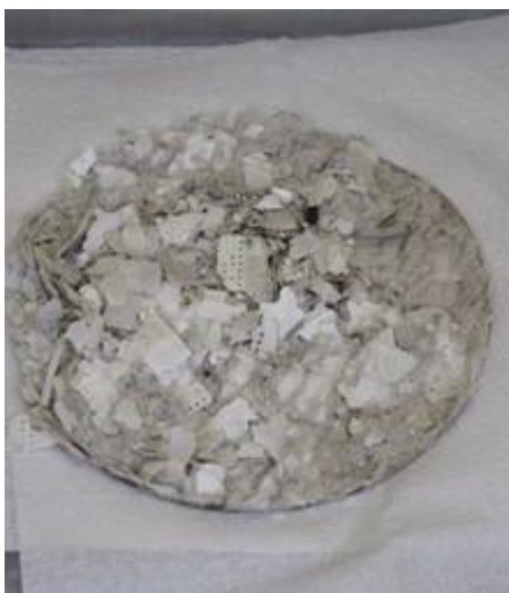
図 4-2-6 粗粉碎のみで仮焼した電子基板
