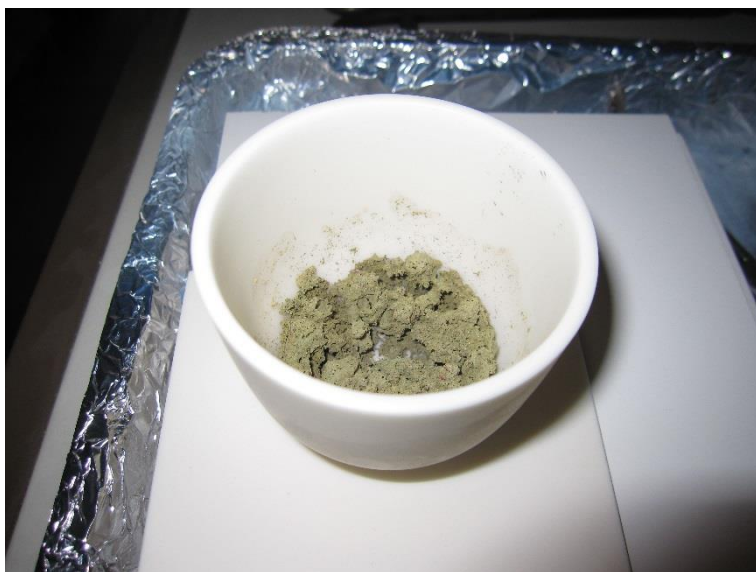
図 4-4-5 吸着剤のばい焼試験(700°C処理後)
