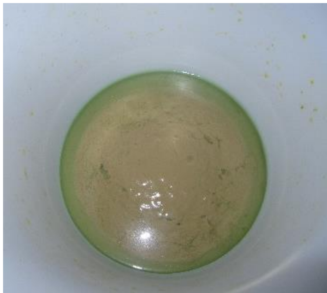
図 4-4 電子基板王水浸出液と混合後の自然沈降した吸着剤
