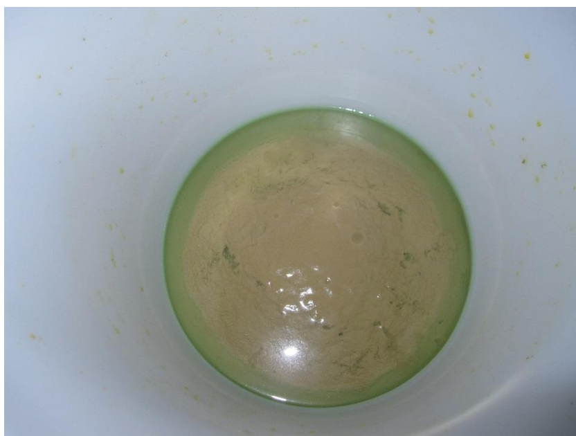
図 4-5-13 自然沈降による固液分離後の吸着剤
