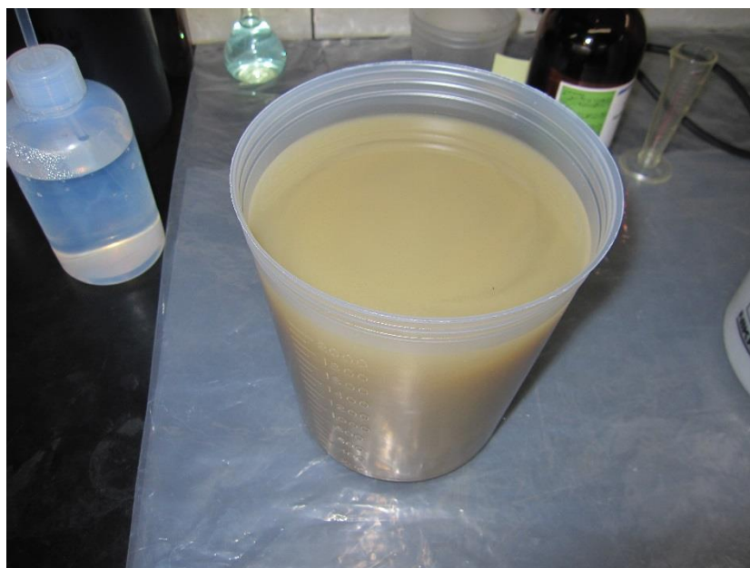
図 4-5-14 0.1M 塩酸で洗浄後(1回目)の吸着剤
