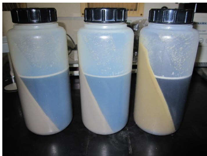
図 4-3-2 ホタテガイ中腸腺由来吸着剤調製(脱脂操作後)
