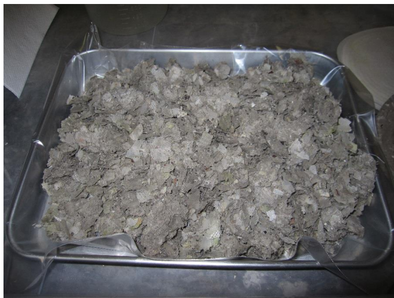
图 4-5-10 浸出残渣 (乾燥後)
