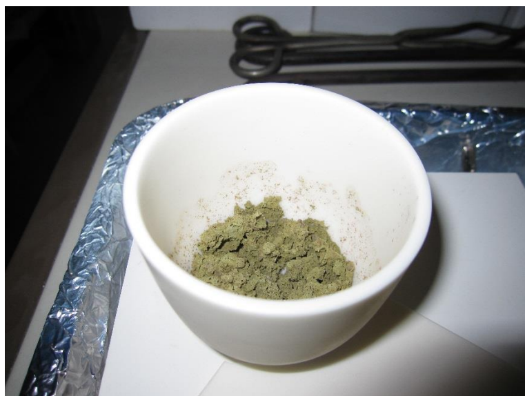
図 4-4-6 吸着剤のばい焼試験(800°C処理後)
