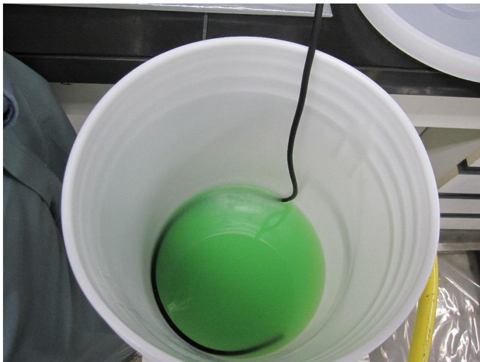
図 4-3-4-4 再洗浄済み吸着剤を用いた固液分離（回収した上澄み）
