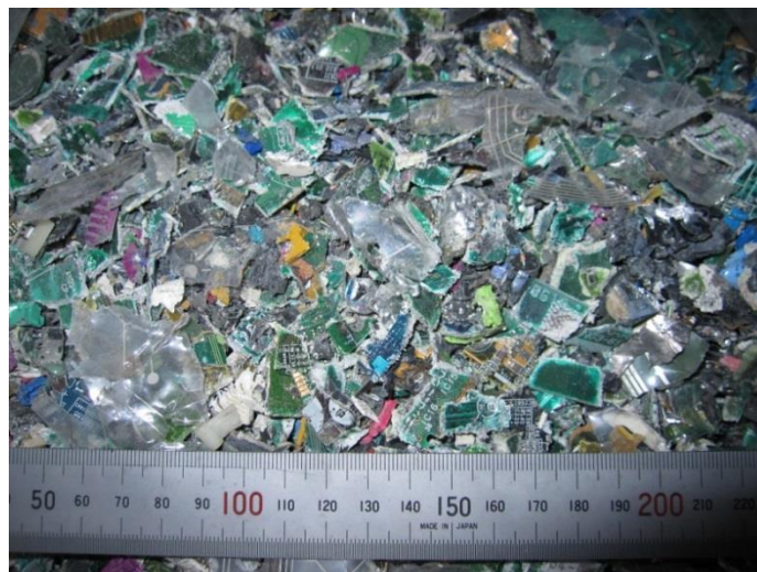
図 4-1 粗粉碎後の電子基板
