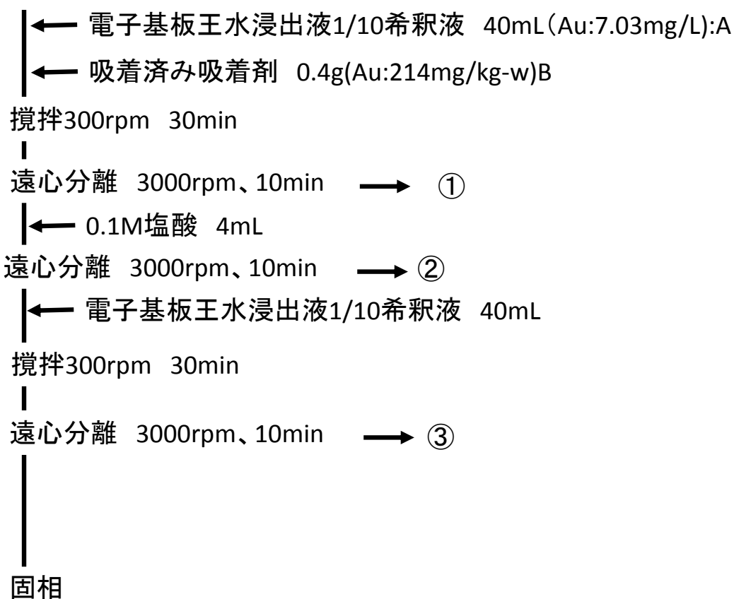
図 4-3-3-1 3回吸着試験フロー
