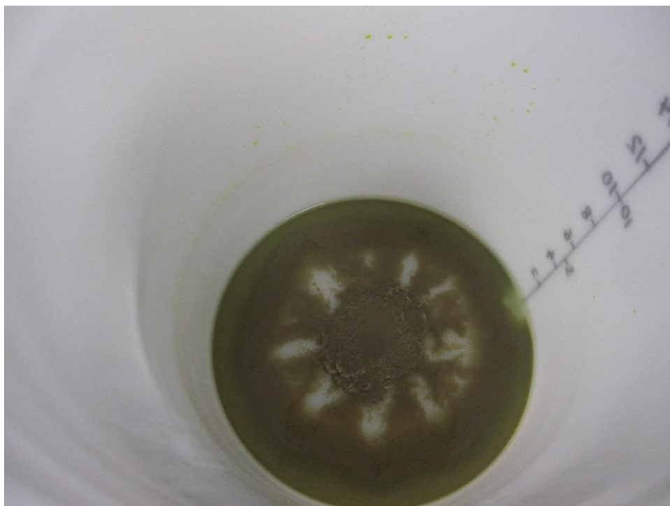
図 4-3-4-6 再洗浄済み吸着剤を用いた固液分離（分離された吸着剤）
