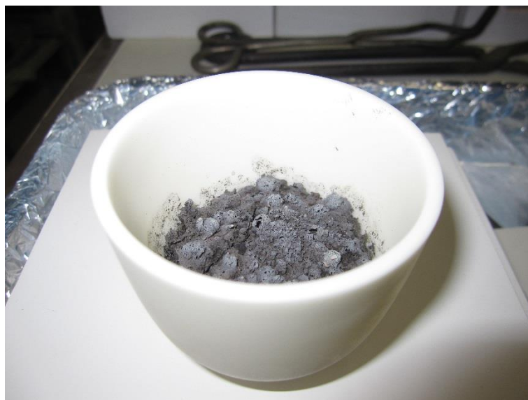
図 4-4-3 吸着剤のばい焼試験(500°C処理後)
