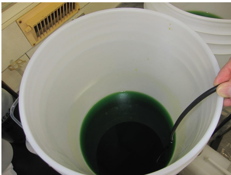
図 4-5-12 自然沈降後の固液分離
