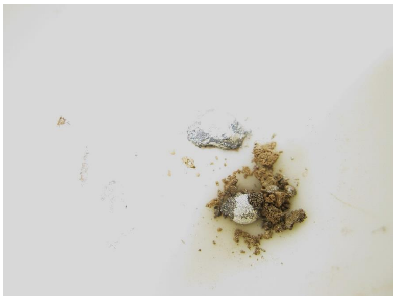
図 4-4-8 粗貴金属の再溶解後硫化物沈殿生成ばい焼後
