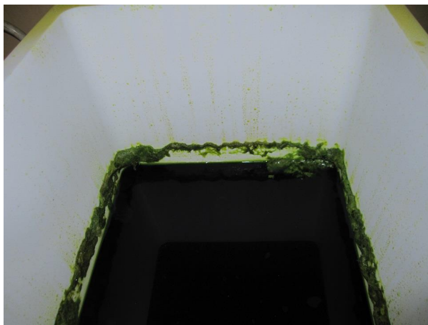
図 4-5-5 浸出反応後の反応槽
