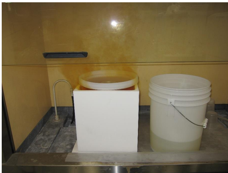
図 4-5-3 1/2 に希釈した王水(右)と浸出反応中の仮焼物
