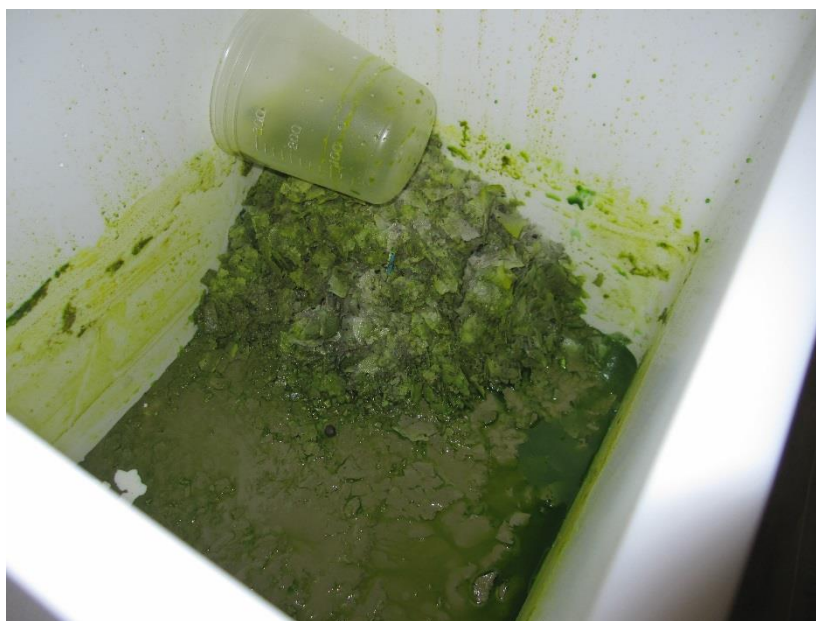
図 4-5-7 浸出後の固液分離（浸出残渣）
