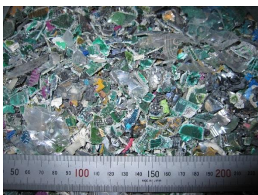
図 4-1-3 粗粉碎後の電子基板
