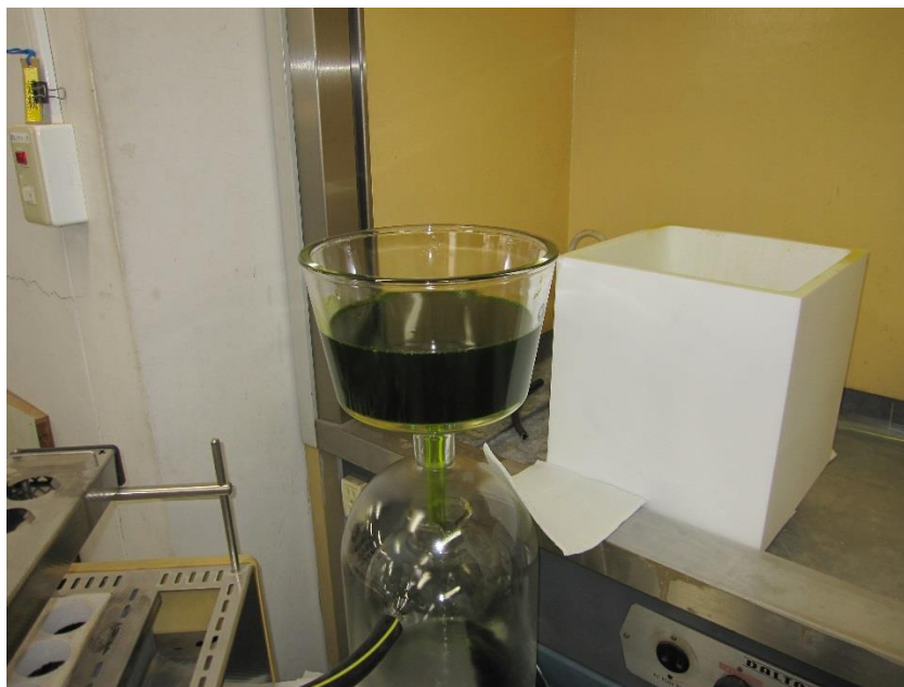
図 4-5-6 浸出後の固液分離操作
