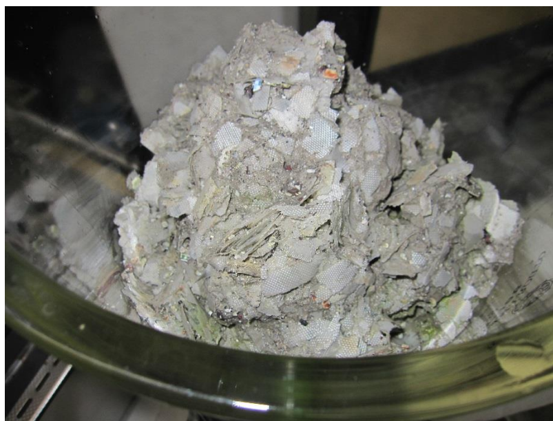
図 4-5-9 水洗浄後の浸出残渣
