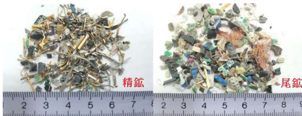
図 34 磁力選別で分けた精鉱と尾鉱 (パソコン由来廃電子基板)
