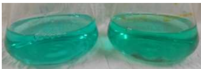
図 18 集積培養系 NE の培養液 (左はコントロール (無植菌)) 培養条件: 45°C、pH 1.9、7 mM Fe 2+ 、重金属イオン: 0.1M)
