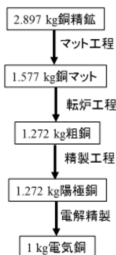
図 8 銅精鉱からの電気銅生産における原料バランス
