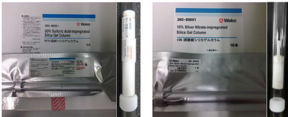
図8 本研究で開発したプレセップ型の55%硫酸シリカゲルカラムと10%硝酸銀シリカゲルカラム
