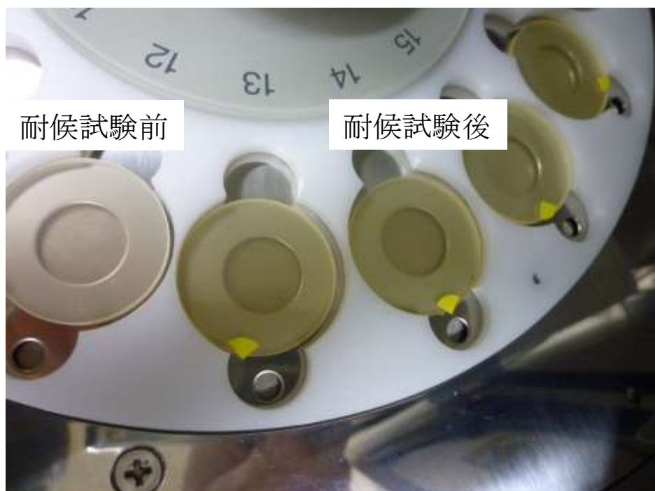
図 11 耐候試験前後の PC 樹脂試料の概要
