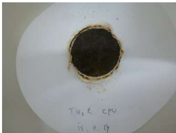
図 69 アスコルビン酸で還元処理した析出物（CPU、酸化処理済）
