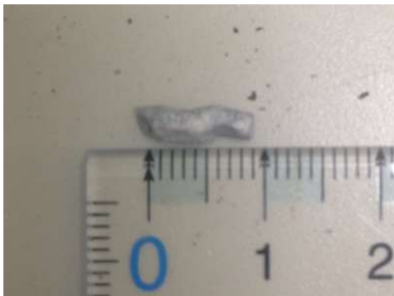
図 64 酸化チタン粒子と共に回収された半田の塊
