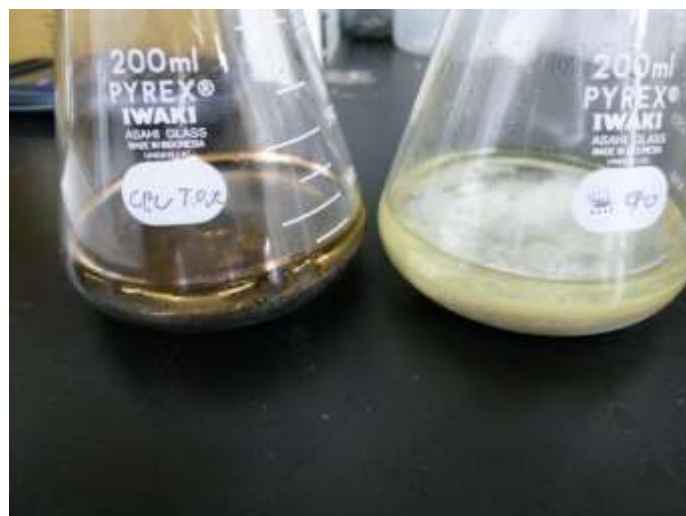
図 68 アスコルビン酸での還元後の CPU 投入溶媒 (左：酸化処理済、右：無処理)
