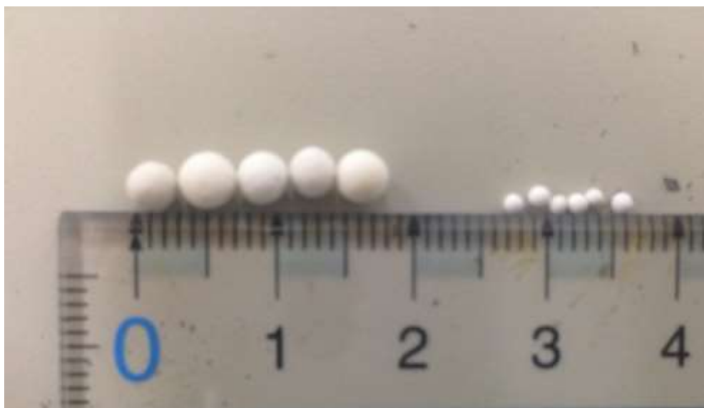
図 6 粒径 3.5 mm の酸化チタンと粒径 1.8 mm の酸化チタン粒子
