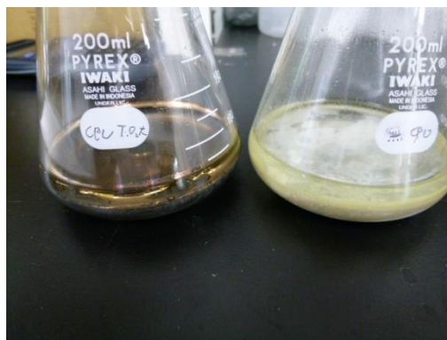
図7 アスコルビン酸での還元後の CPU 投入溶媒 (左：酸化処理済、右：無処理)
