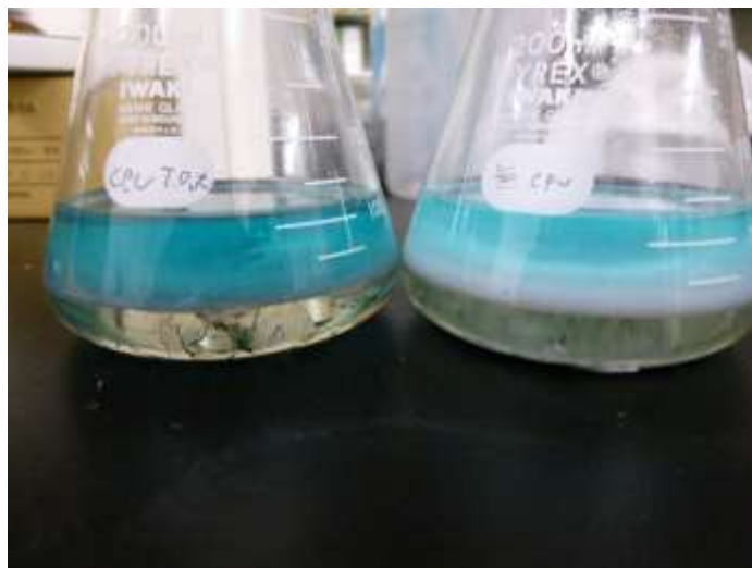
図 67 硫酸を入れ 1 昼夜静置後の CPU 投入溶媒 (左：酸化処理済、右：無処理)
