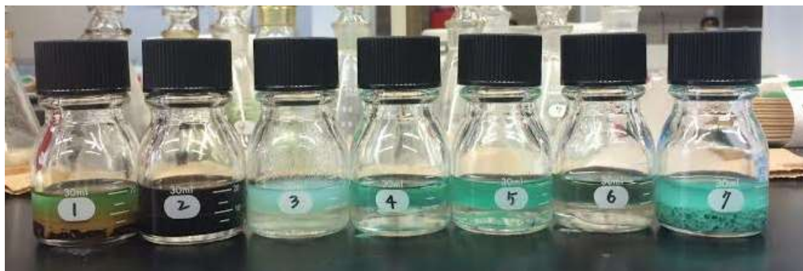
図 48 塩酸による二層分離後の各溶媒（左から Au、Pd、Sn、Zn、Ni、Co、Cu）
