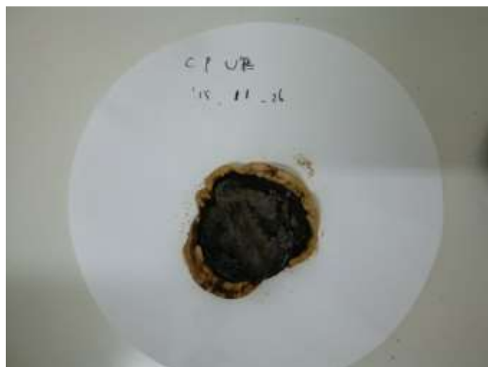
図 70 アスコルビン酸で還元処理した析出物（CPU、無処理）
