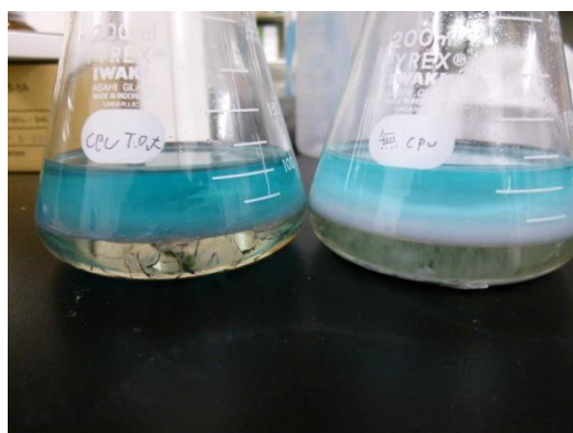
図 6 硫酸を入れ 1 昼夜静置後の CPU 投入溶媒（左：酸化処理済、右：無処理）
