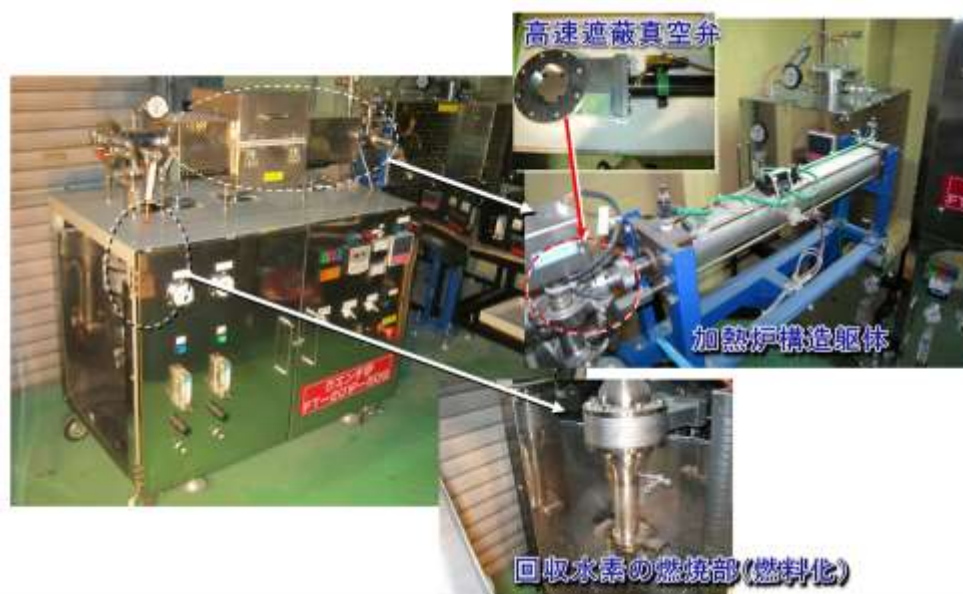
図 12. 脱水素化同時焼結工程に用いる横型雰囲気管状炉の外観および内部構造
