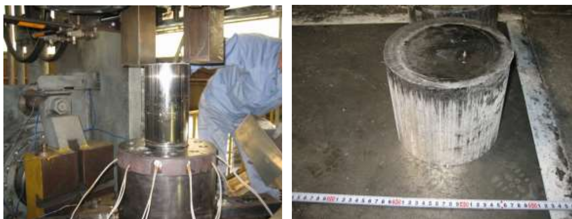
図 20. 大型焼結体の外観写真（直径 \phi 165mm 素材）
