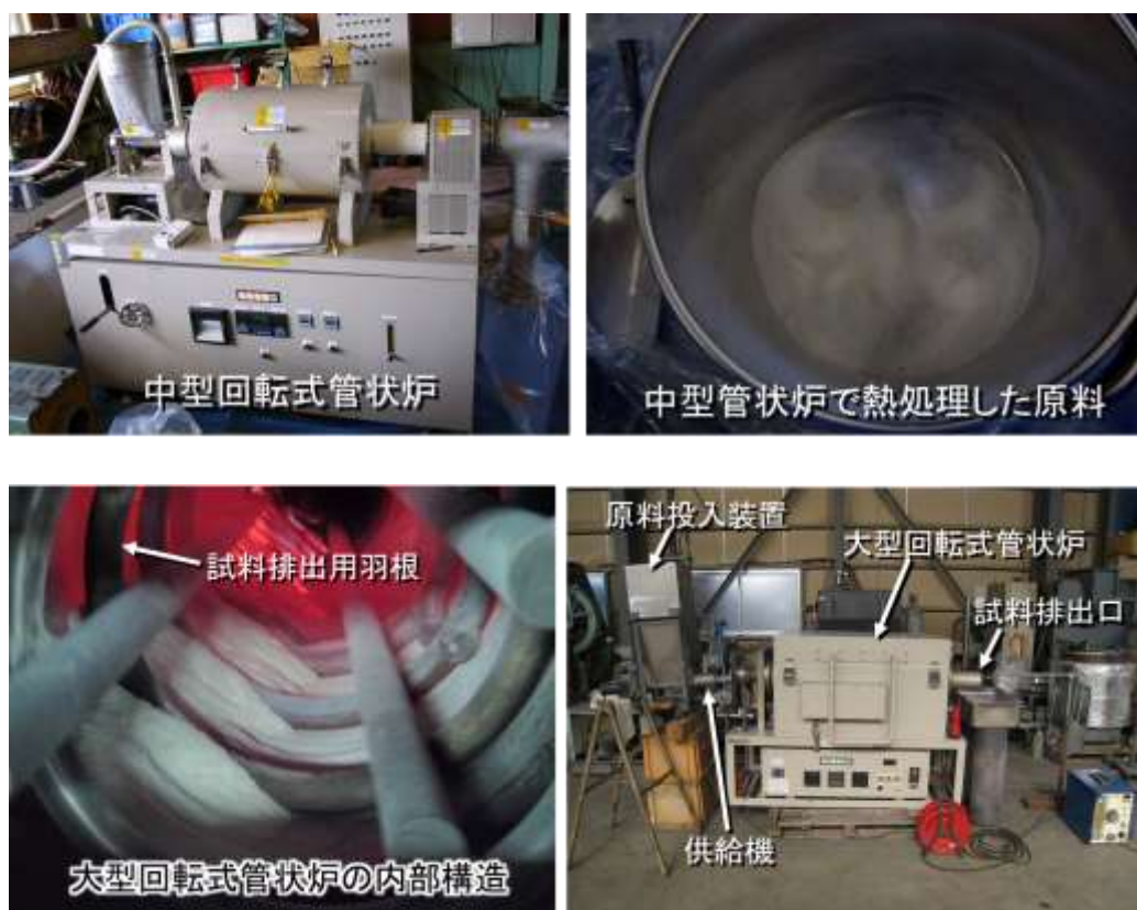
図 19. 試作実験に用いた大型および中型回転式管状熱処理炉の外観
