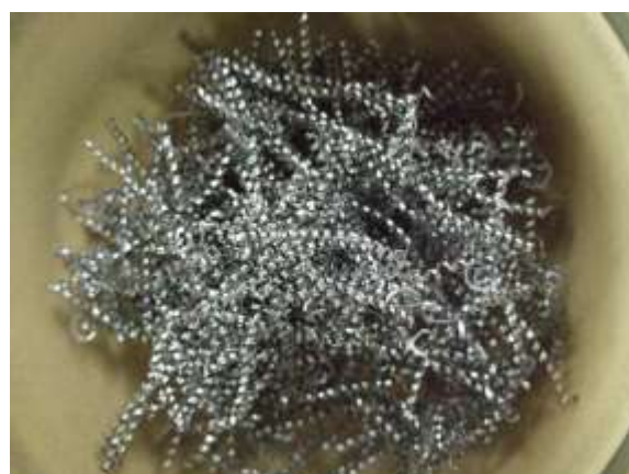
図 9. 回転ボールミル装置のポット内に充填した Ti-64 合金の切削屑（図 8 の切粉 B）
