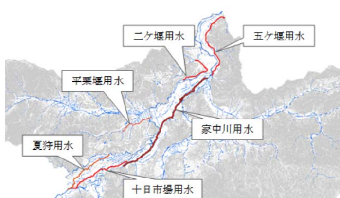
図(1)-12 小水力発電の利用可能ポテンシャル推計の対象とした6用水
