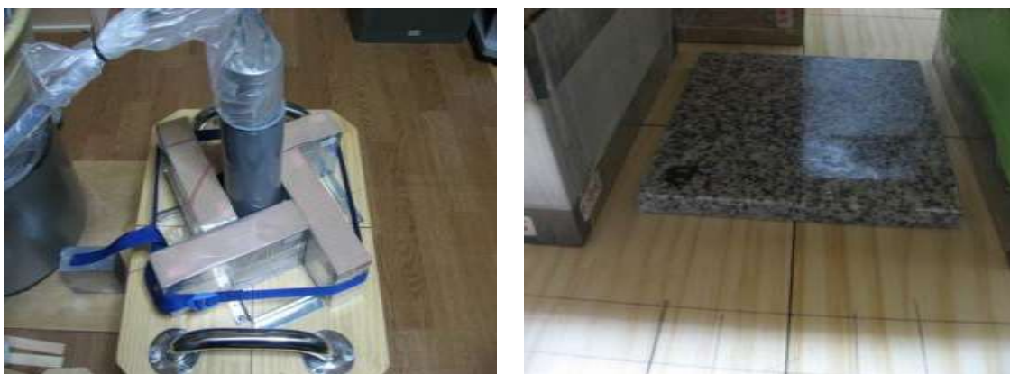
図(1)-34 2” NaIシンチレータを用いた全放射能の測定
