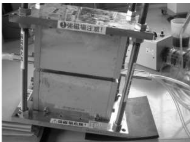
図(3)-14 永久磁石による汚染土壌の磁気分離の実験装置
