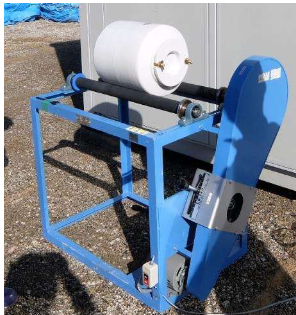
図(3)-12 大型ボールミル装置
