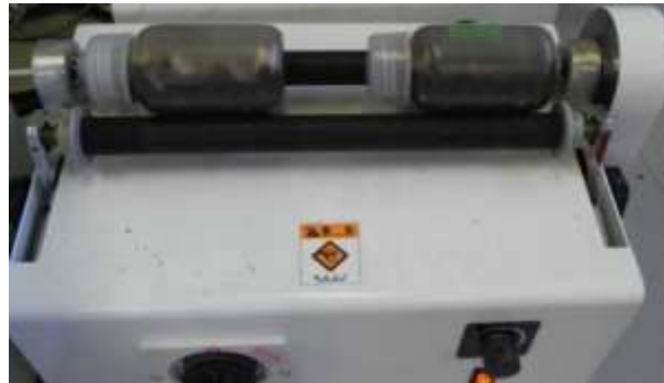
図(3)-7 小型ボールミル装置
