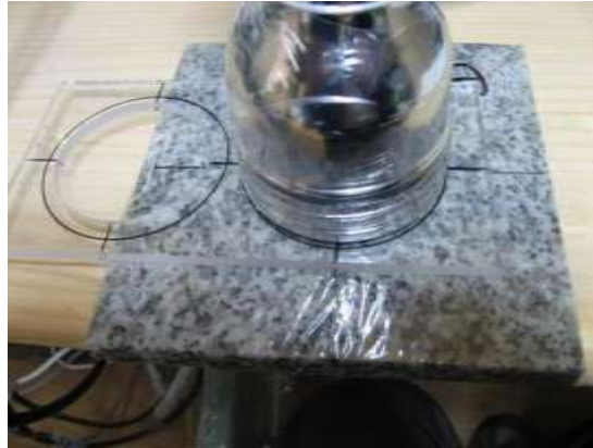
図(1)-29 アクリル板を用いたガンマ線成分の測定
