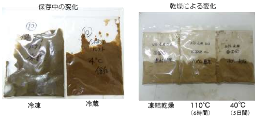
図(1)-21 保存および乾燥による試料状態の変化（水田土壌試料）
