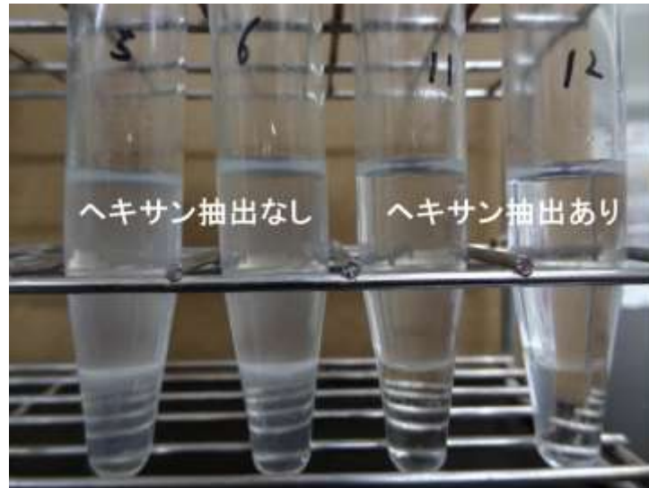
図(1)-10 ヘキサン抽出処理の有無によるEDTA逆抽出溶液の状態 (上層：トルエン相、下層：EDTA水溶液相)
