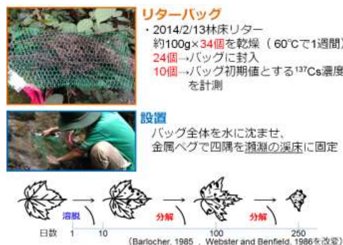
図(1)-5 リターバック実験の設置手順と回収
