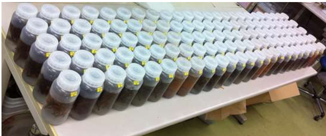
図(1)-6 リターからの放射性セシウム溶脱に関する実験の様子
