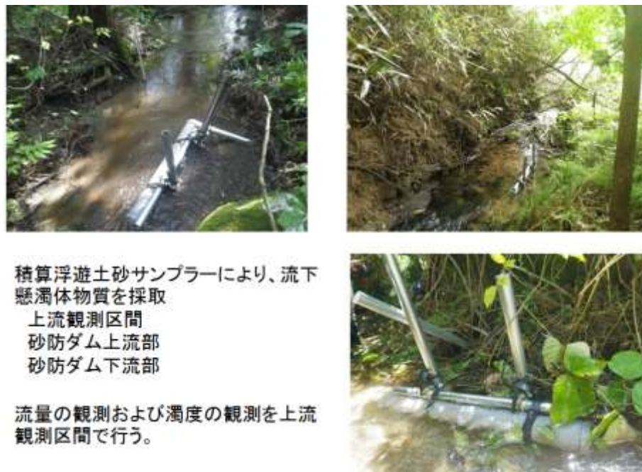
図(3)-2 浮遊土砂流出、流量、濁度の観測
