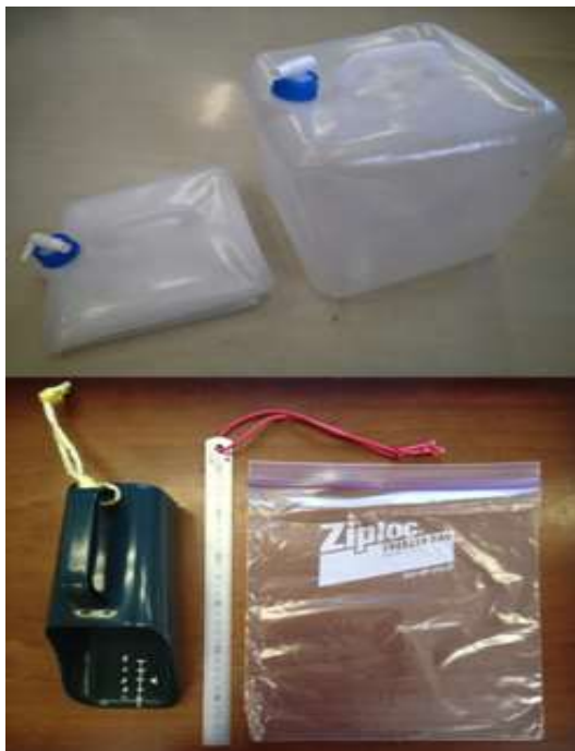
図(2)-2 海水採集用ポリエチレン製折りたたみ式タンクおよび砂泥採集用プラスチック製土すくいとチャック式ビニール袋。
