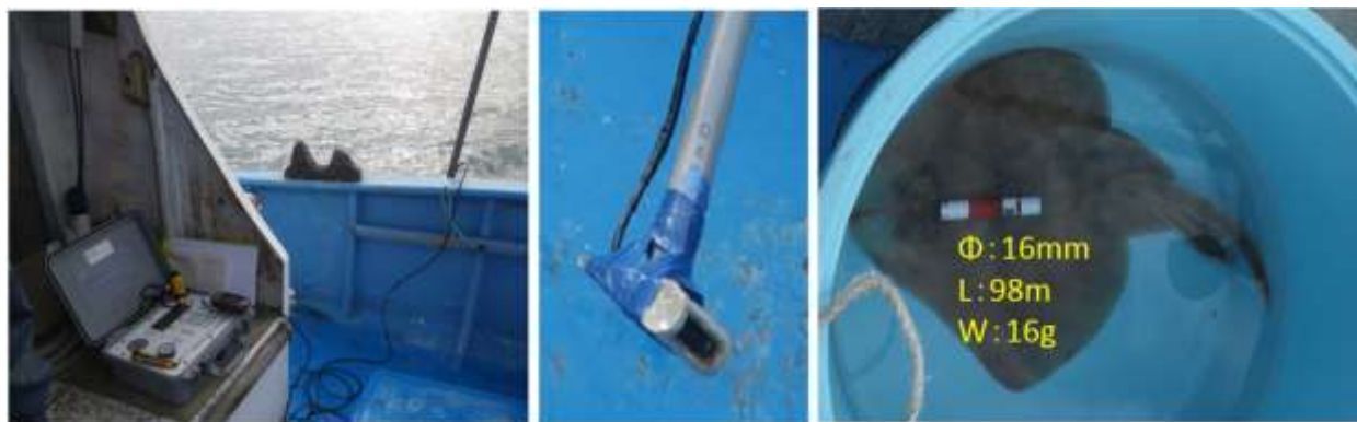
図(3)-7 追跡型バイオテレメトリーシステムVR100（写真左），VR100指向性受波器（写真中央），超音波発信機（V16P）を装着したコモンカスベ（写真右）。
