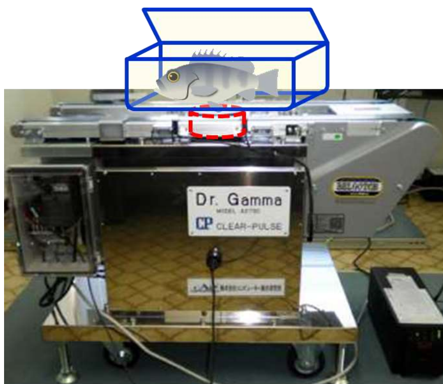
図(1)-3 NaI シンチレーションカウンタによる放射性セシウム計測の模式。 赤い点線は NaI 結晶の検出部を示す。
