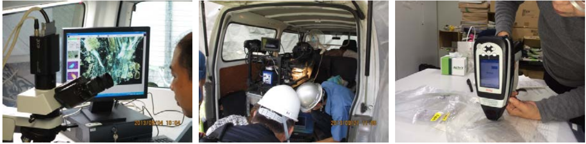
図 2-4 現場で評価した迅速判定方法（左：車載偏光顕微鏡法、中：車載近赤外測定装置、右：可搬型近赤外測定装置）
