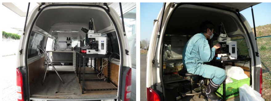
図 2-2 現場での石綿分析の様子
