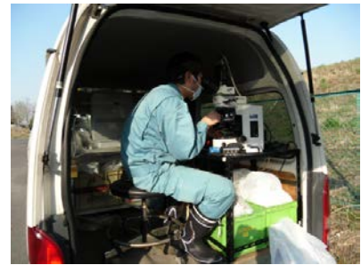
図2 現場での石綿分析の様子
