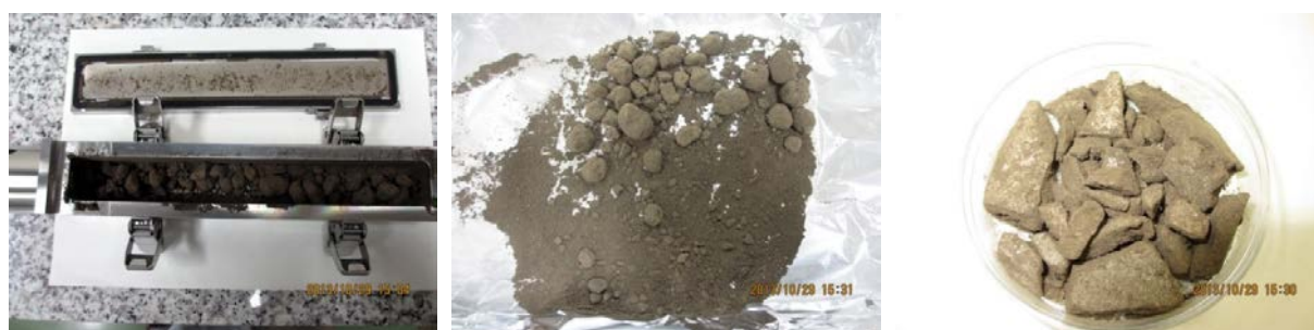
図 2-17 模擬混入土壌実験後のタンブラーの状況(左)、分離した土壌(中)と石綿含有建材(右)
