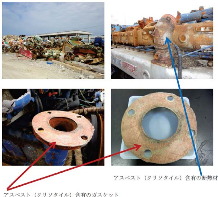
図 3-3 石綿(クリソタイル)を含有するガスケット及び布状の断熱材
