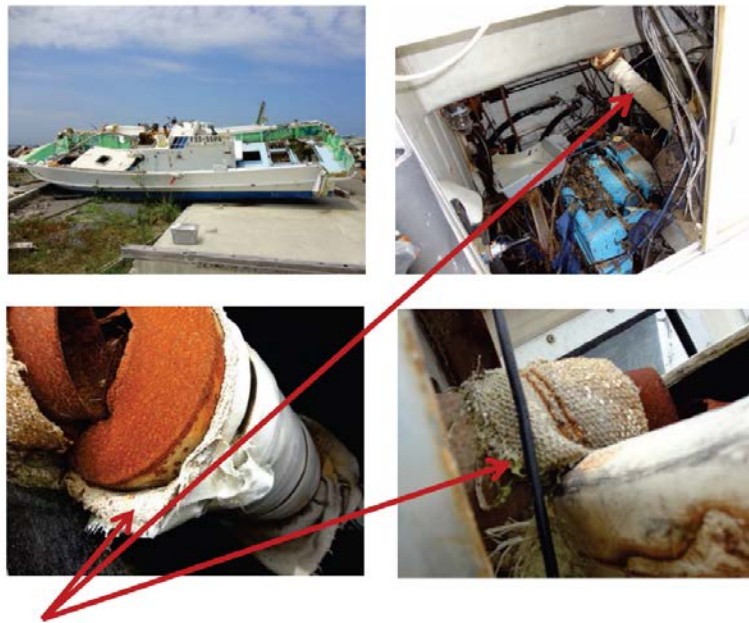
アスベスト(クリソタイル)を含有する布状の断熱材
