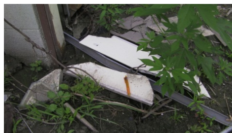
(a) 波形スレート板の破損が確認できる事例 (b) 押出成形板が多量に散在している事例
