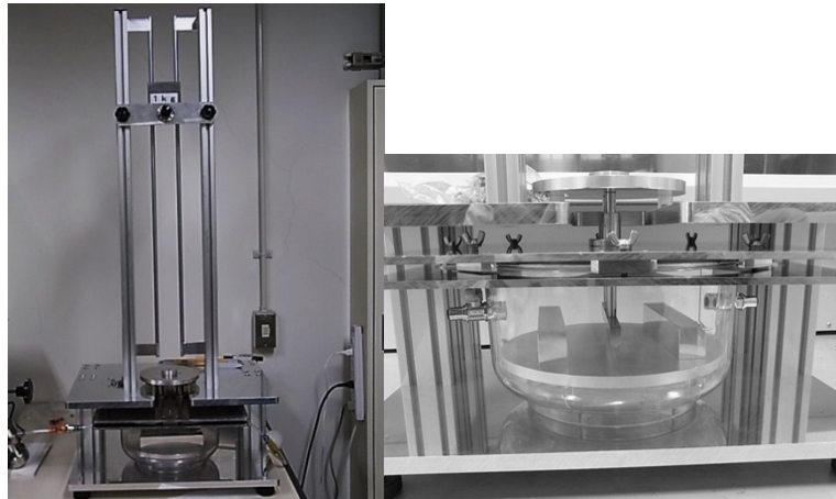
図 2-13 衝撃試験機全景(左)と衝撃試験機容器部分(右)
