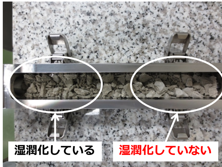
図 3-18 水分割合 7.1%のケースでの湿潤化後の建材の状態
