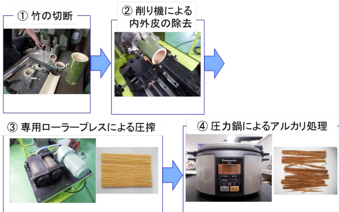
図 19 産学共同研究により開発した前処理機械と市販圧力鍋を使用する竹繊維の新しい製造工程。
