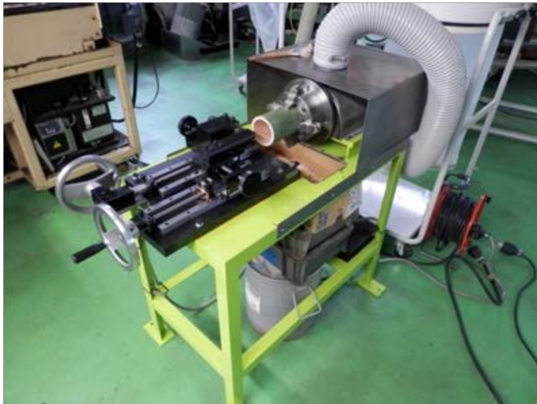
図5 開発した竹加工機。(上) 竹の内外比除去機プロトタイプと (下) 簡易型竹の内外比除去機。
