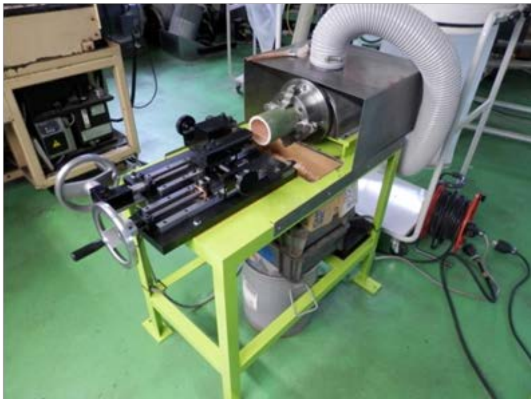
図 17 開発した竹加工機。(上) 竹の内外比除去機プロトタイプと (下) 簡易型竹の内外比除去機。
