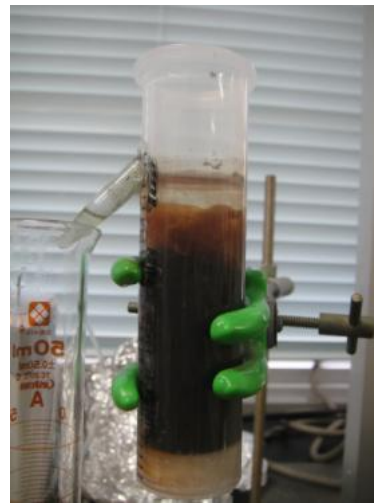
写真 3-3-5-3 吸着・脱着の繰り返しに伴うカラム状況の変化(3 回目の状況)
