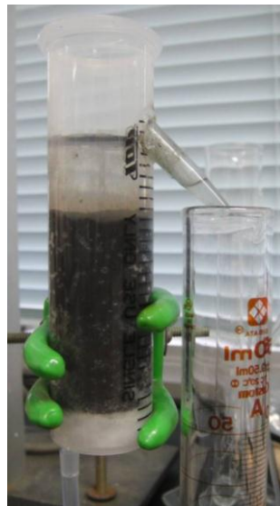
写真 3-2-3 カラム実験装置 (ジルコニウム系吸着材を充填した場合)
