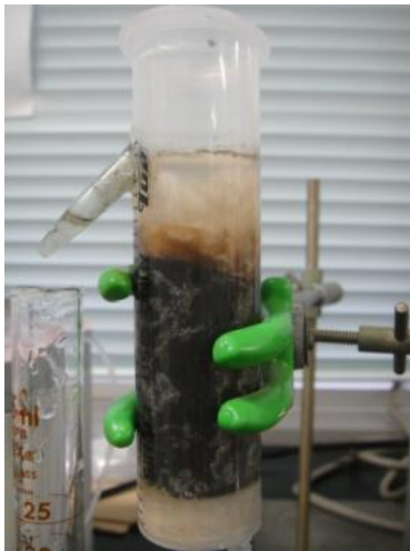
写真 3-3-5-3 吸着・脱着の繰り返しに伴うカラム状況の変化(3 回目の状況)
