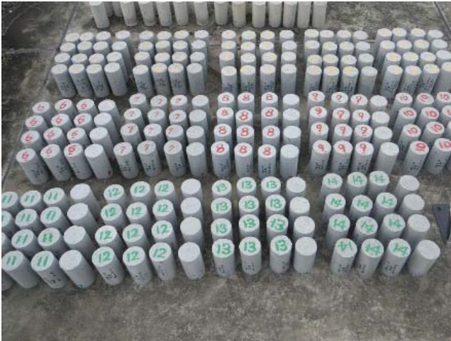
写真 3.3.1 長期暴露中性化試験体の暴露状況
