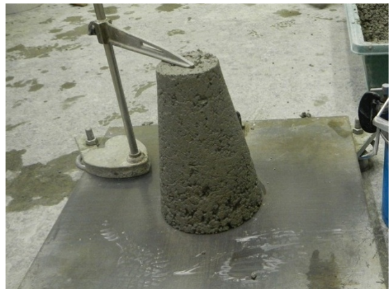
写真 3.4.2 スランプの経時変化(45%-SR(6550)50-B40-N10(A), 左：練直, 右：30分経過)
