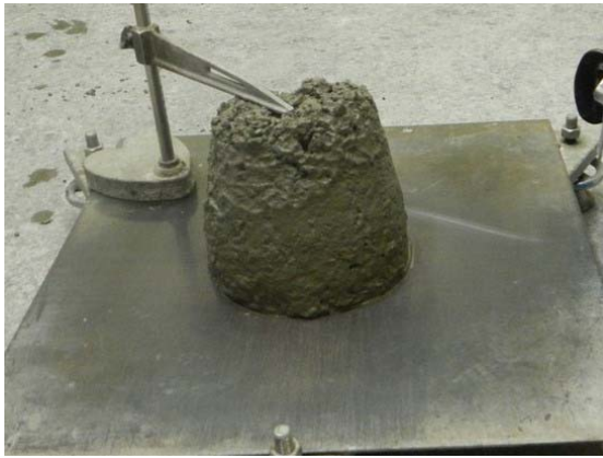
写真 3.4.1 スランプの経時変化(45%-N(A), 左：練直, 右：30分経過)
