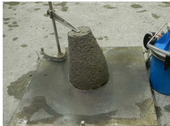
写真 3.4.3 スランプの経時変化(45%-SR(6550)50-B40-N10(B), 左：練直, 右：30分経過)
