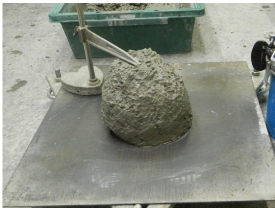
写真 3.4.2 スランプの経時変化(45%-SR(6550)50-B40-N10(A), 左：練直, 右：30分経過)
