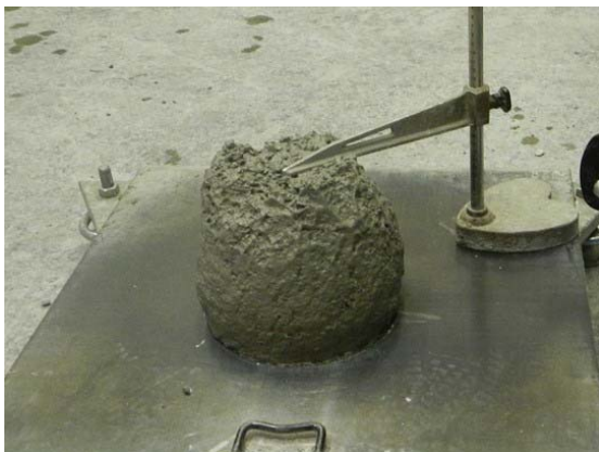
写真 3.4.3 スランプの経時変化(45%-SR(6550)50-B40-N10(B), 左：練直, 右：30分経過)
