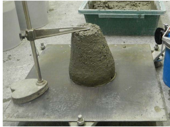
写真 3.4.1 スランプの経時変化(45%-N(A), 左：練直, 右：30分経過)
