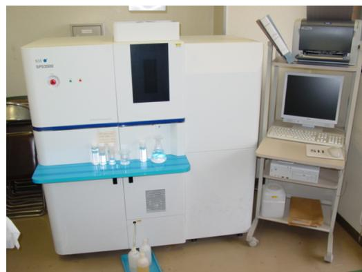
図 9 ICP 発光分光分析装置
