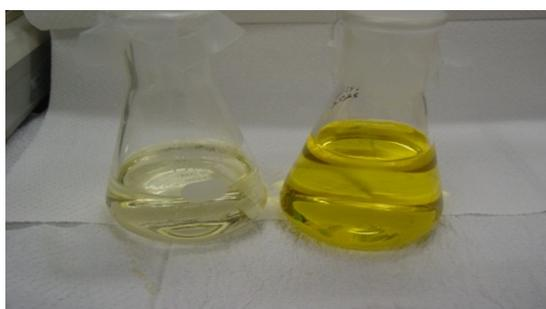
図 16 Run 3（残渣 A）に用いた金属溶液の外観(左：アスコルビン酸添加、右：無添加)
