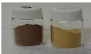
図 15 亜鉛精錬残渣（左：残渣 A、右：残渣 B）
