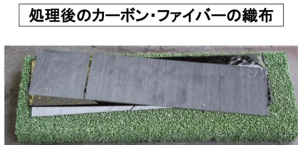
図 22 処理後の CFRP（左図の右側試料）
