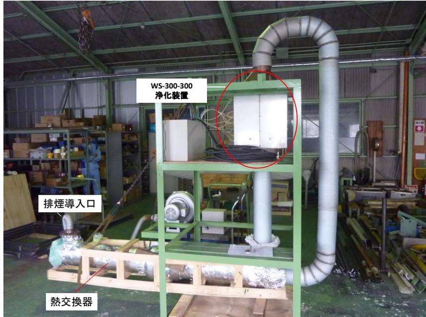
図 12 VOC 浄化装置（WS-300-300）を熱交換器と結合した複合装置
