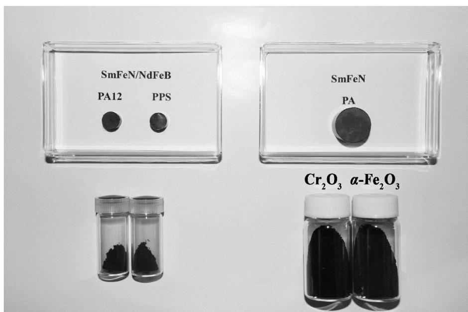
図 3 円筒形状のボンド磁石と回収された磁性粉：PA12, PA はナイロン系樹脂を示し、PPS はポリフェニレン・サルファイド樹脂である。さらに、 $\text{Cr}_2\text{O}_3$ ならびに $\alpha\text{-Fe}_2\text{O}_3$ は TASC 処理に使用した酸化物半導体を意味する。
