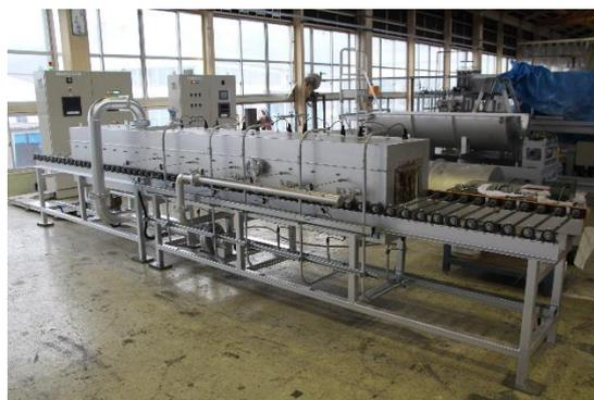
図 20 トンネル炉の実機
