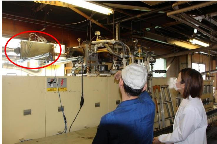
図 11 グラファイト製造工程のトンネル型装置
