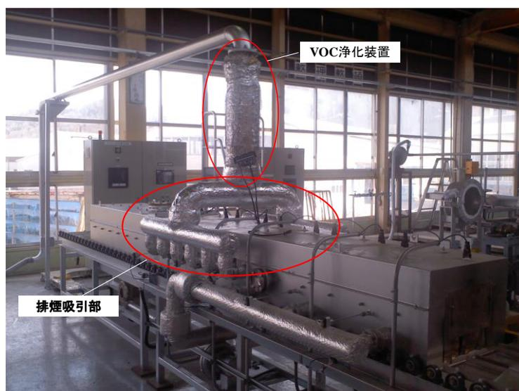
図 25 VOC 浄化装置と排煙吸引パイプを装備したトンネル炉
