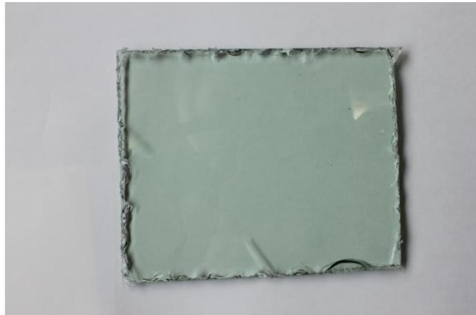
図2 合わせガラス (トヨタ:クラウンのフロント・ガラス)
