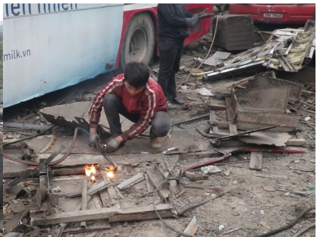
図5 ELVの解体作業
