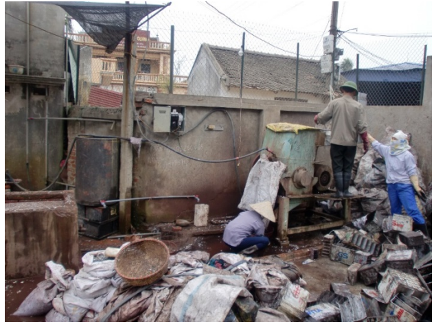
図2 バッテリーケースの洗浄と粉碎
