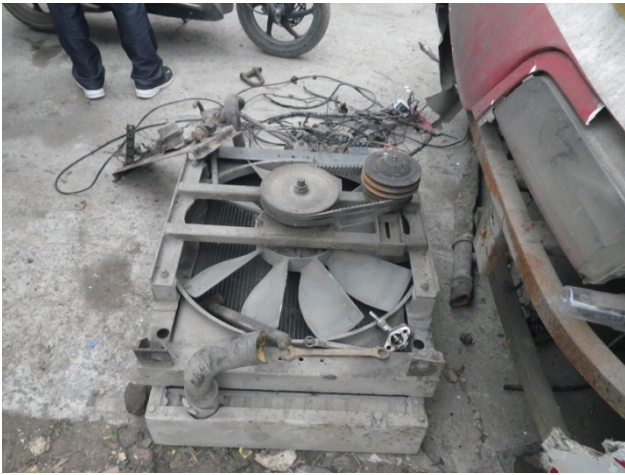
図6 解体されたカーエアコン
