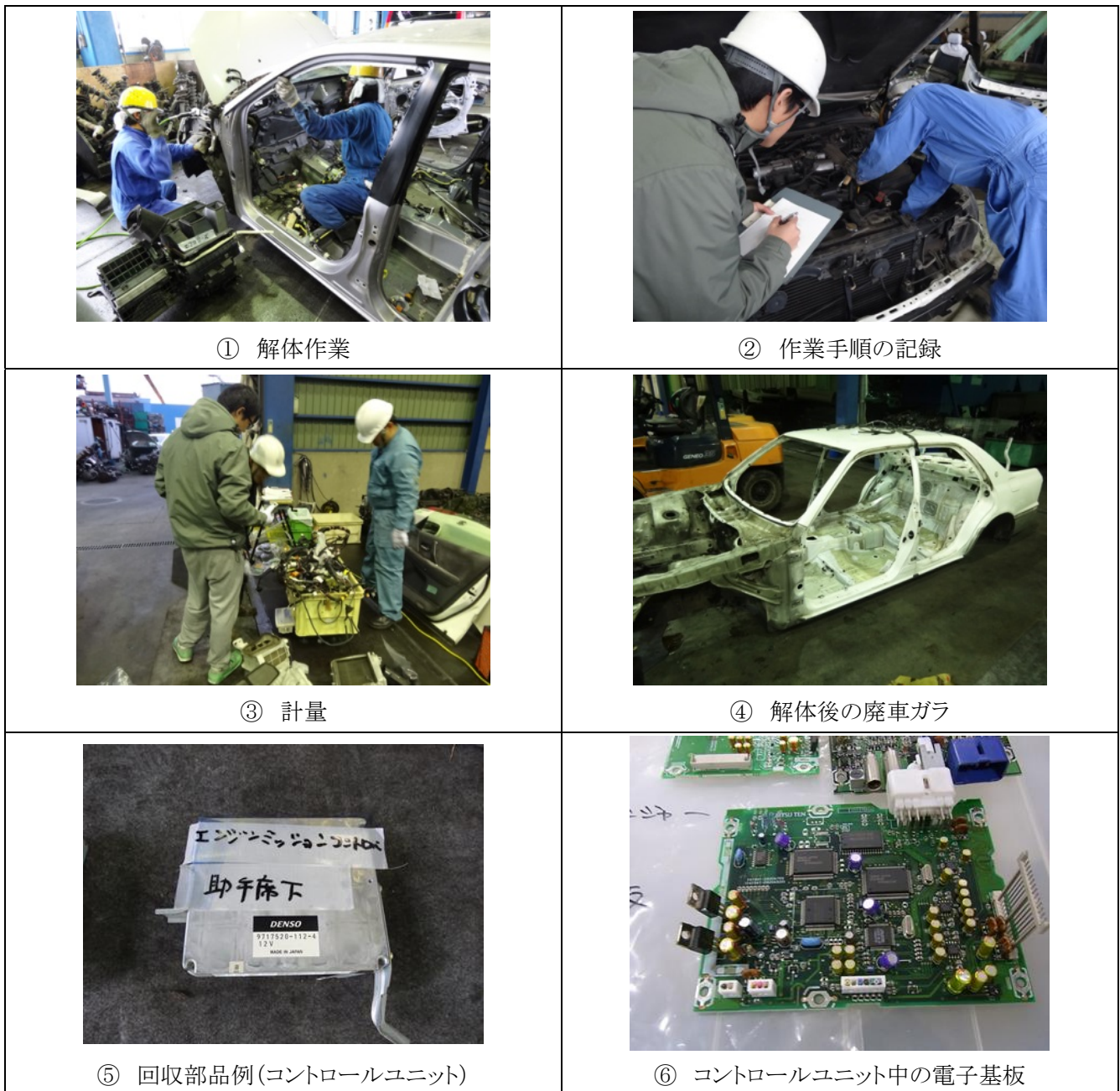
図1 解体調査手順
