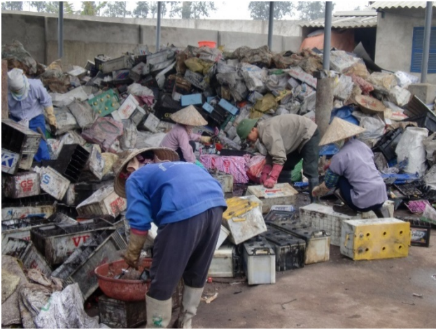
図1 廃鉛バッテリーの解体
