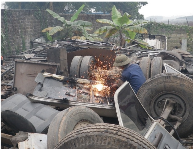
図5 ELVの解体作業
