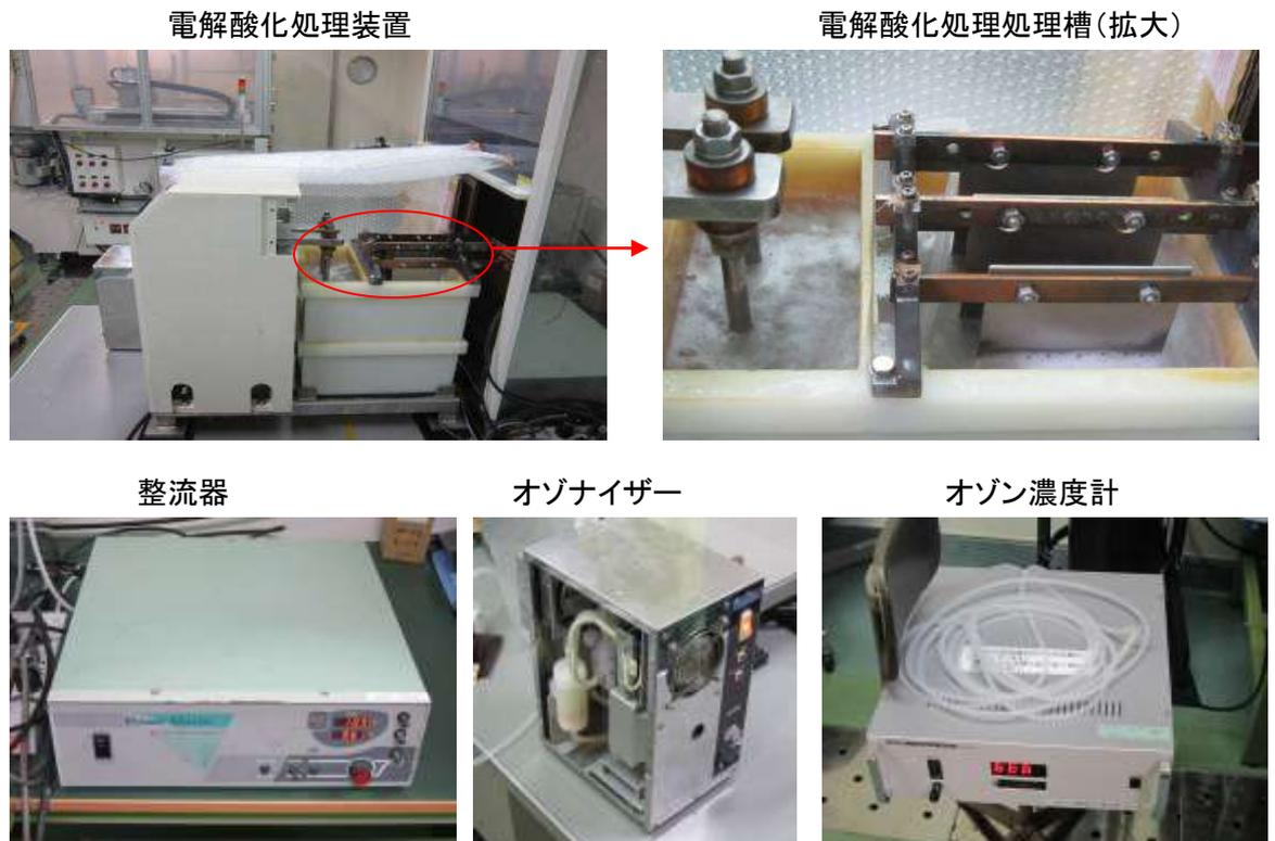
写真 10 電解・オゾン処理併用実験装置
