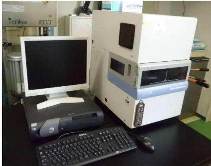
写真2 キャピラリー電気泳動分析装置
