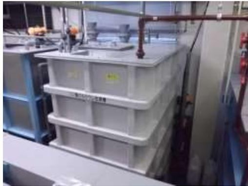
C5 リン酸カルシウム 沈降槽
