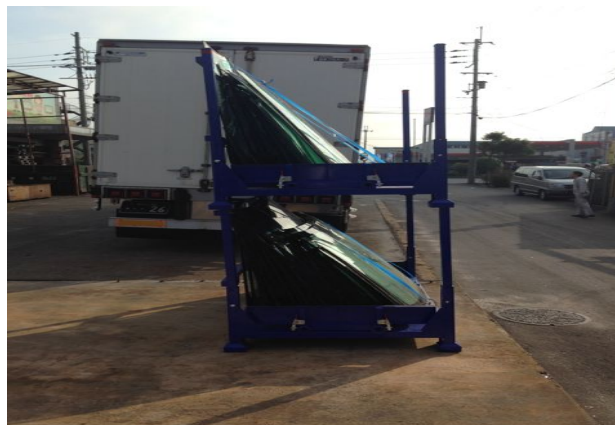
図6. ガラス積載状況
