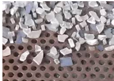
図4：焼却後のスクリーン選別（粒度選別では素材単位の選別ができない）
