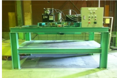
図6：実機は油圧押し出し式
