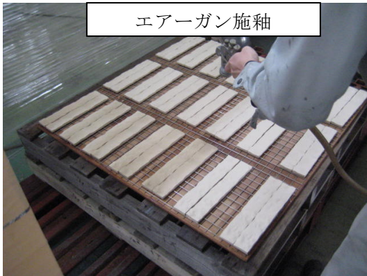
図4：ローラー及びスプレー釉薬加飾
