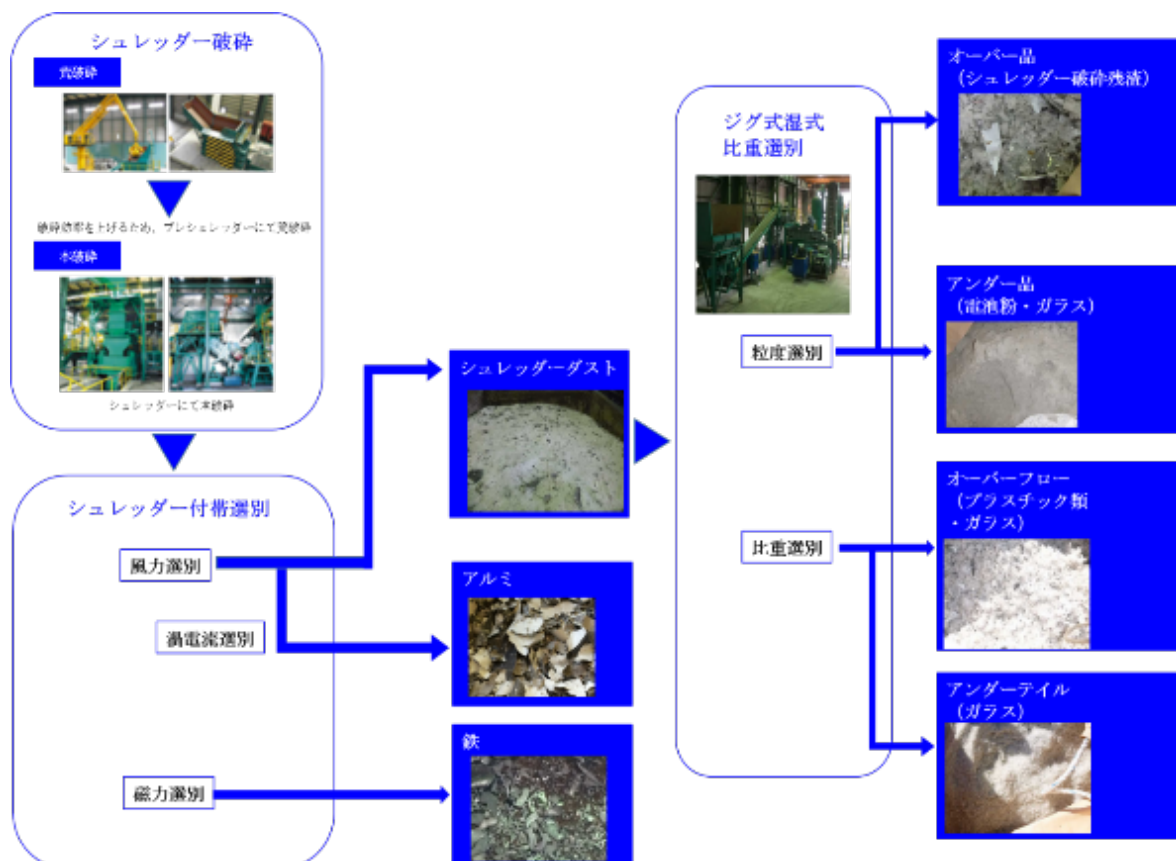
図 7：太陽光パネルリサイクルにおける全体の工程フロー
