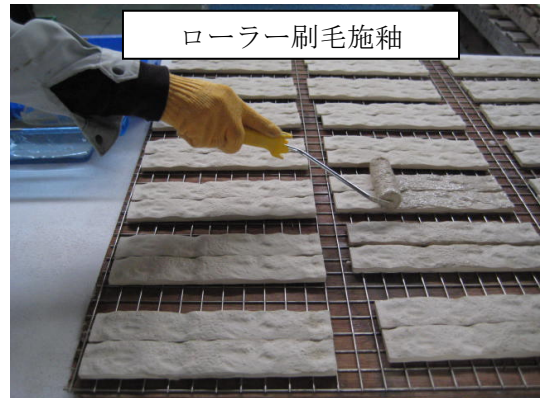
図4：ローラー及びスプレー釉薬加飾
