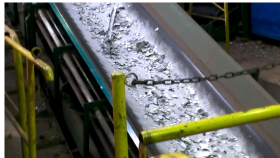
図5：シュレッダープラントによる破碎
