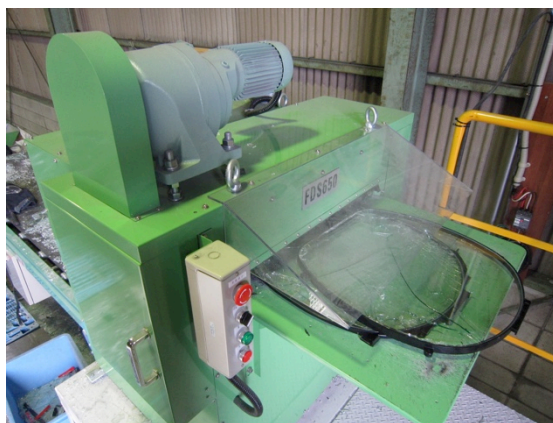
図 3 : 破砕機による外フレームの分離
