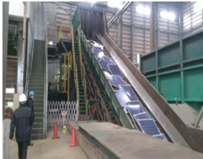
図5：シュレッダープラントによる破碎
