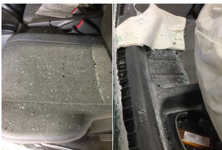
図5：切断後のガラス飛散状況
