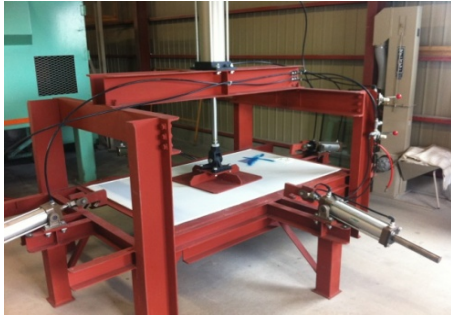
図5：エアシリンダーの引っ張り実験
