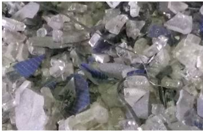
図4：焼却後のスクリーン選別（粒度選別では素材単位の選別ができない）
