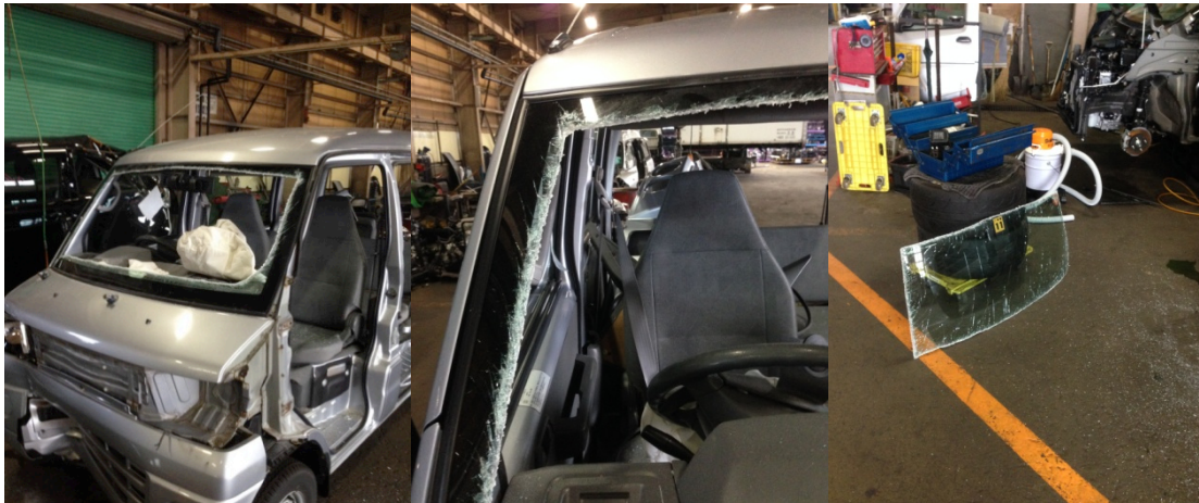
図9：切断後車両とガラス
