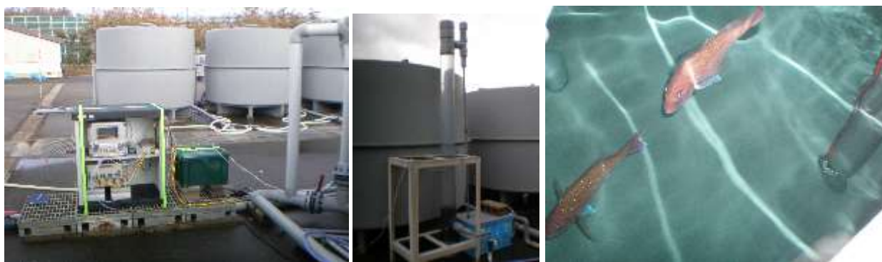
図(1)-3 大型水槽(10t)の二酸化炭素分圧調整予備試験。左：可搬型二酸化炭素分圧計測装置の設置、中：10t水槽の脇に二酸化炭素溶解塔を設置、右：蓄養中のマダイと設置した投げ込み式平衡器。
