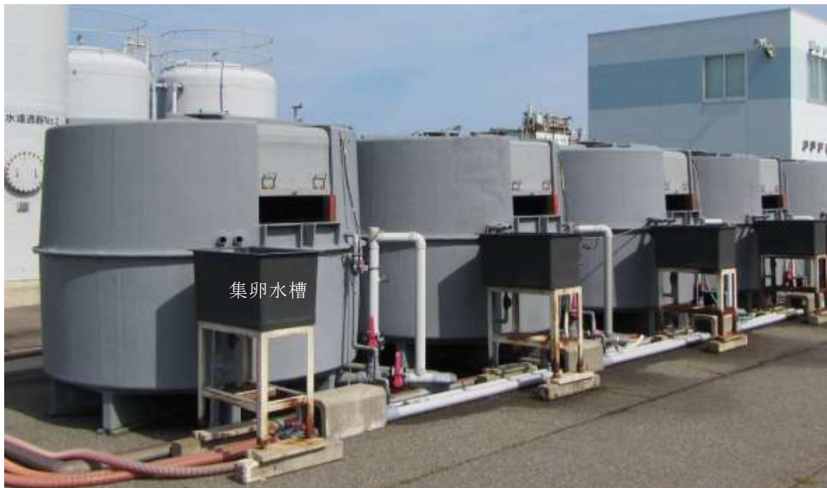
図(3)-1 シロギスの産卵適水温の調査に用いた実験水槽と集卵水槽。実験水槽には、FRP製の円形水槽（容量5t、直径約2.5m×高さ約2.5m）を用いた。集卵水槽には、FRP製の角形水槽（容量約200L、底面積約4,000cm 2 ×高さ約50cm）を用いた。
