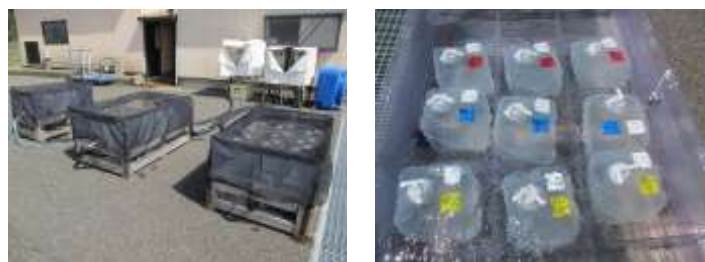
図(4)-3 柏崎実証試験場における5Lポリエチレンバックを用いた沿岸海水培養実験の様子(2014年)。3段階の水温および3段階のCO 2 分圧の実験区を設定し、各実験区について3連で培養した。
