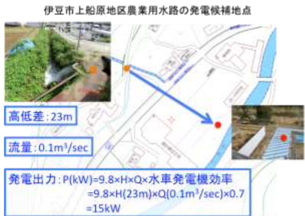
図(1)-4 小水力発電開発計画の概略検討（伊豆）
