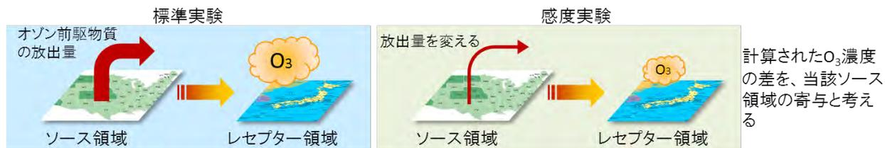
図(2)-4：エミッション感度法の概念図。
