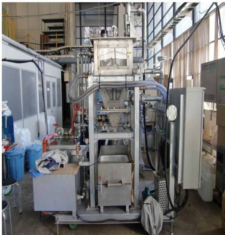
図(1)-9 空気揚土攪拌式洗淨装置とその洗淨工程における土壌と水のフロー
