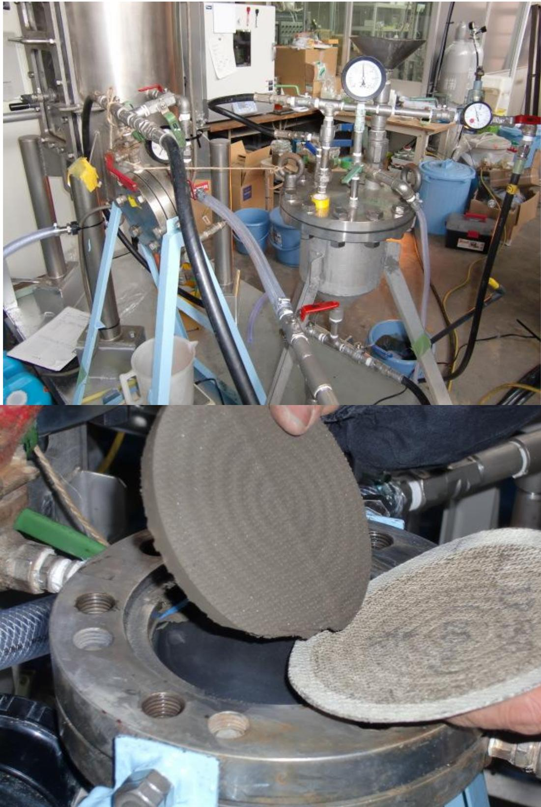
図(1)-26 脱水装置による土壌洗浄液中の土壌粒子の回収.
