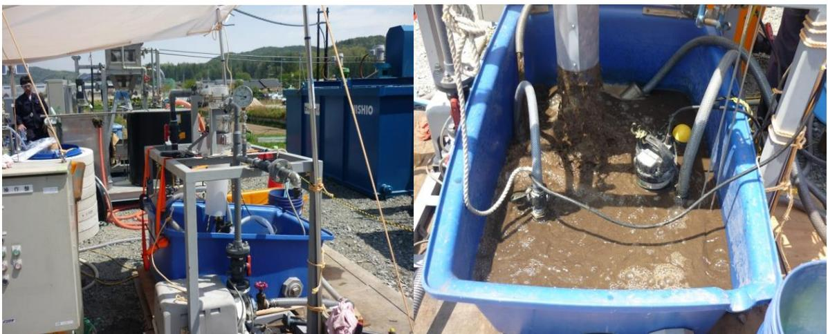
図(1)-14 福島県川内村に設置したサイクロン分級装置.
