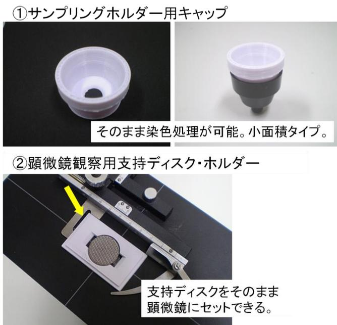
図(1)-23、作製した蛍光法用の補助具（白い造形物）。
