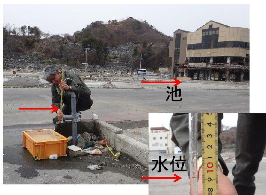
図(3)-3：深井戸の地下水位計測の様子
