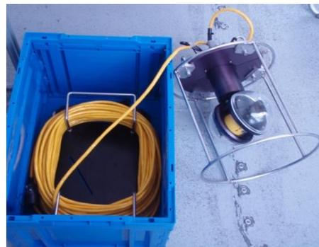
図(4)-2 CTDシステムに搭載した硝酸塩センサー(左)と水中クロロフィル可変蛍光光度計(中央)、水中ビデオカメラ(右)
