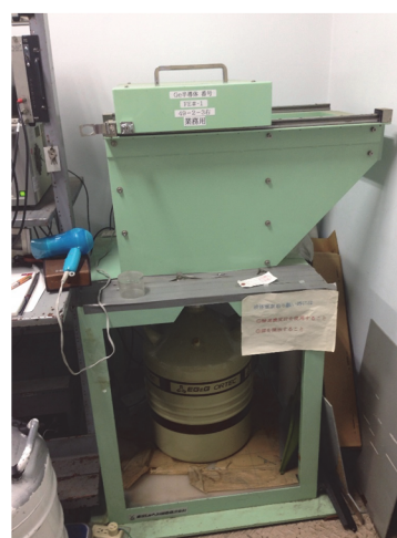
Ge半導体検出器による測定
