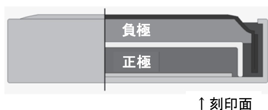
図38 ボタン型電池の内部構造
