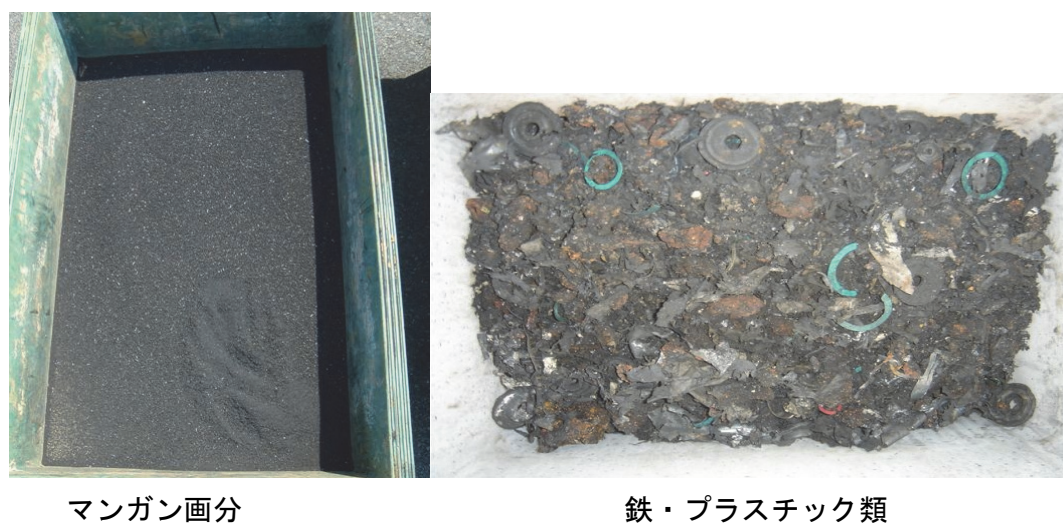
図 13 選別することなく破碎した廃乾電池
