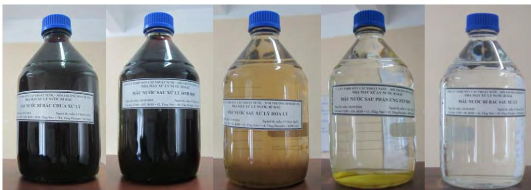
図 8.5 Nam Binh Duong 埋立処分場の浸出水と処理水の外観。(A)浸出水、(B)生物処理後、(C)物理化学処理後、(D)フェントン酸化反応後、(E)処理水
