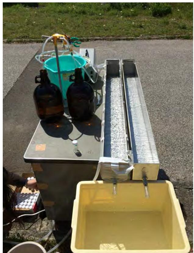
写真5.3 薄層水路での太陽光照射条件下での浄化実験 (左:上流側, 右:下流側)
