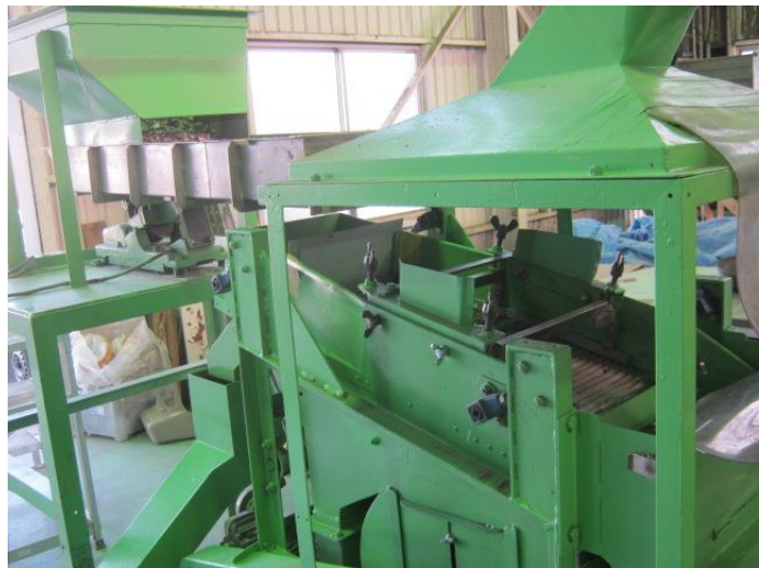
図 6-2 比重差選別装置 SH2（原田産業）
