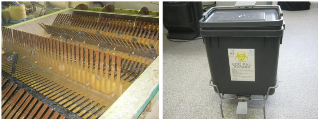
図 7-2 湿式比重差選別機（左図）及びリサイクル製品（右図）
