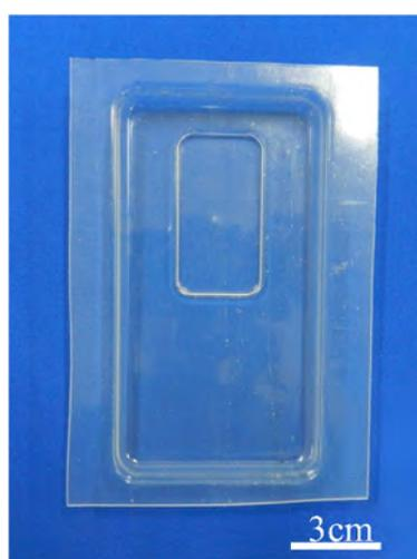
図 4-41 PLA 単体で試作したスマートフォン梱包ケース外観
