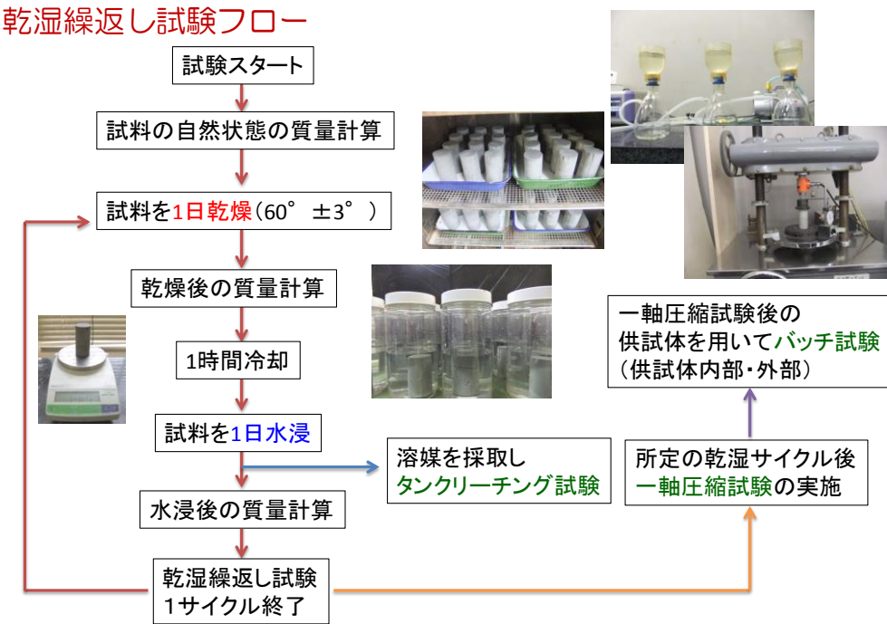
図-5.4 乾湿繰返し試験の一連のフロー
