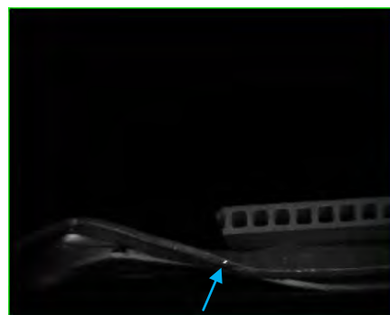
図 2.1.5-16 アルミニウムの強い反射がある判定画像
