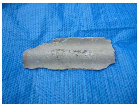
試料 17 クリソタイル 5.9wt%／クロシトライト 0.5wt%
