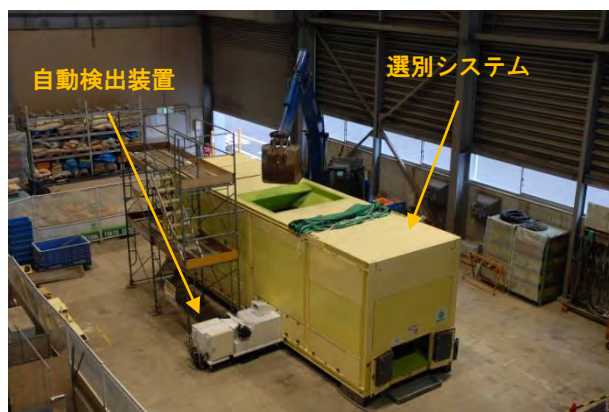
図 5-4 自動検出装置と選別システムの接続
