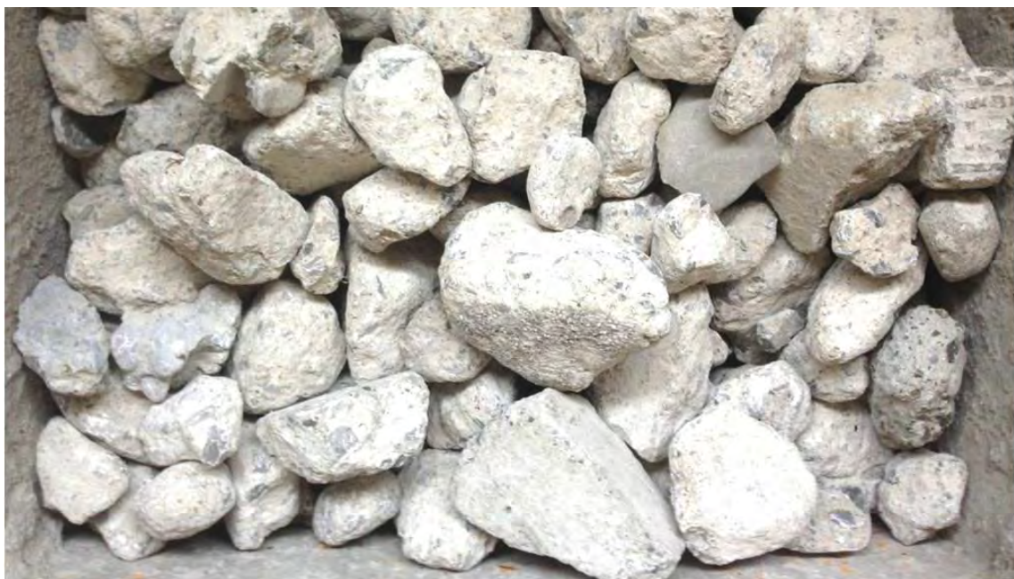
図 2.2.5-6 実験で使用了コンクリート塊のサンプル
