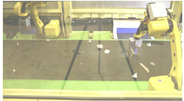
図 3. 3-2 選別ロボットによる廃棄物選別
