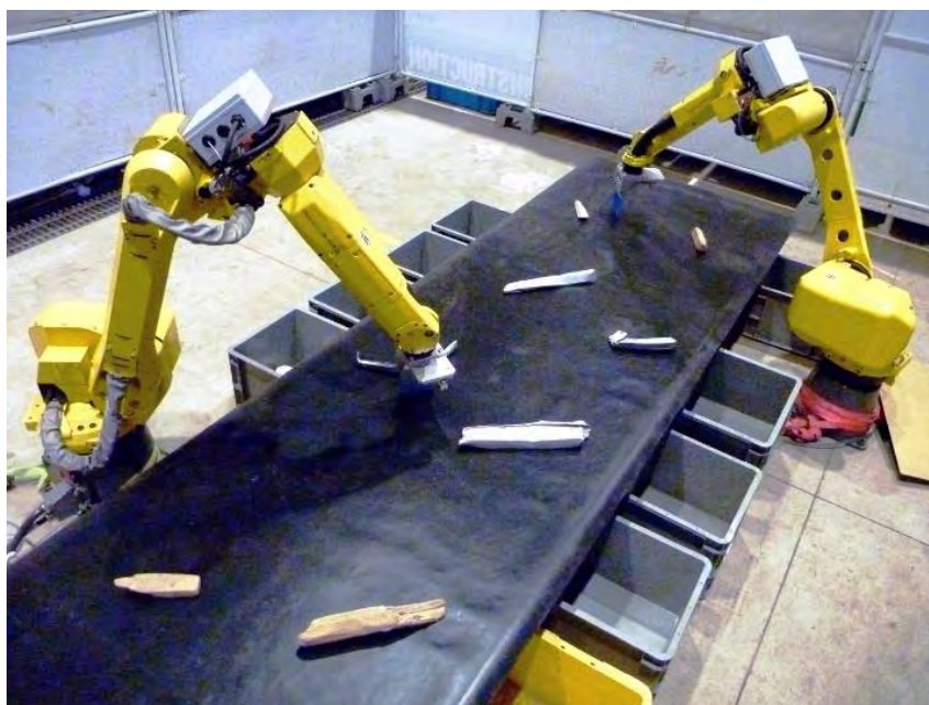
図 2.2.5-2 ツメを使わない直線経路での回収成功率検証予備実験の様子
