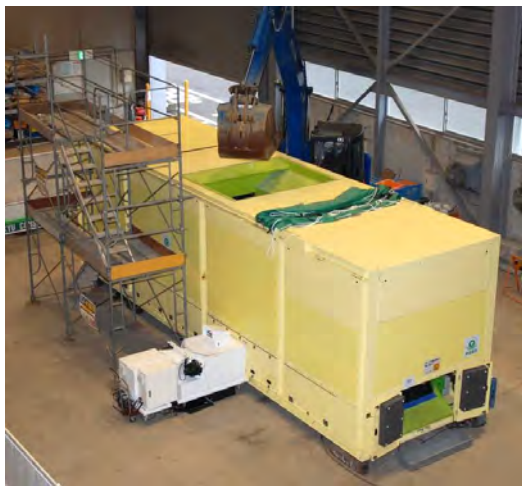
図 3.1.1-1 建設廃棄物選別装置および自動検出装置
