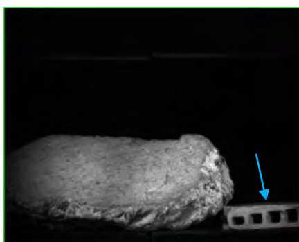
図 2.1.5-15 コンクリート塊に押し出された含有建材
