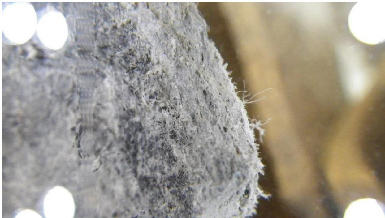
図(1)-18 b 同条件でマイクロを照射しない場合。尖った纖維が破壊されずに残留している。
