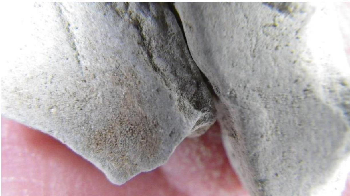
図(1)-18 a 雰囲気温度900°C マイクロ波18kW, 投入量40kg/h 処理後のスレート破碎片。強化繊維が消滅している。
