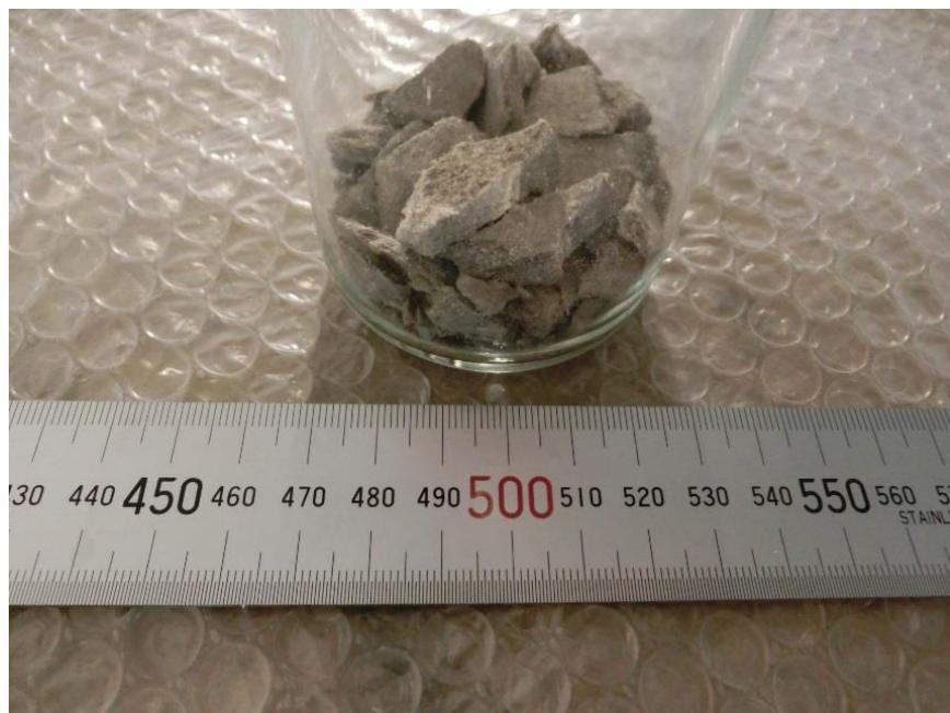
図(3)-3 試料で用いたアスベスト含有スレート瓦
