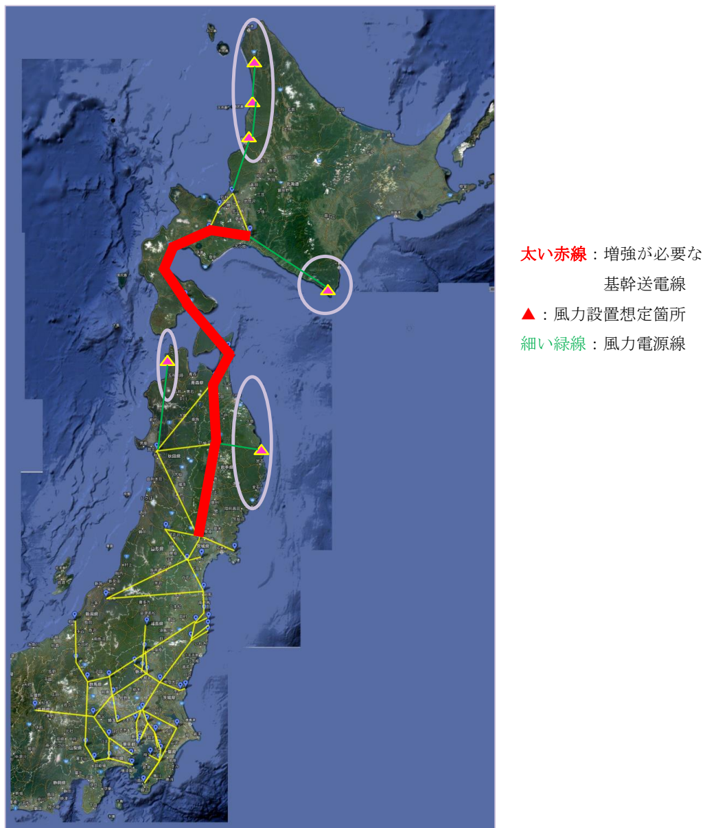
図(1)-32 北本を 8 GWに増強する場合に併せて増強が必要な基幹送電線
