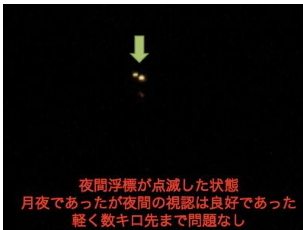
(c) 夜間に漂流させている際の浮標の視認性の確認
