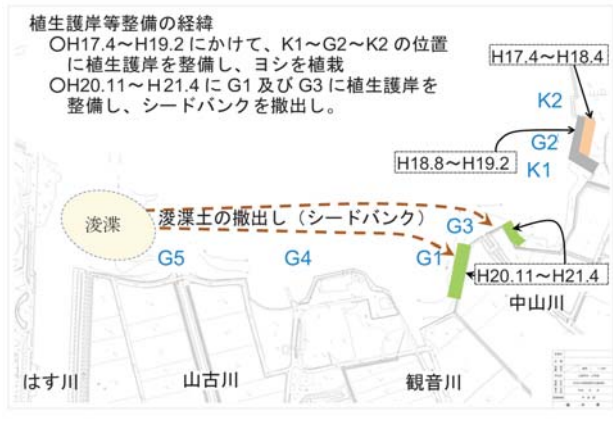
図2 植生護岸整備箇所
