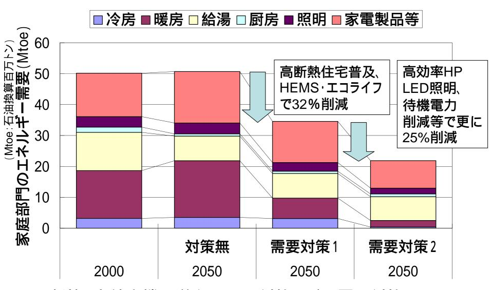
断熱、高効率機器導入、コマメ対策などの需要対策で約6割のエネルギー需要を削減
