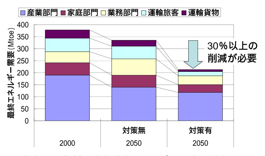
運輸部門は燃料電池自動車やハイブリッド車の導入による飛躍的な(2-3倍の)効率向上により需要を削減する
