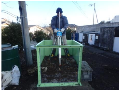
キャスポル (衝撃加速度試験 ／深度方向影響 範囲把握試験)
