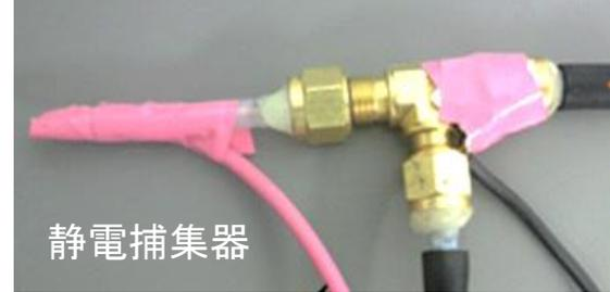
ピーク粒径の粒子を、静電捕集器にて捕集し、ICP-MSにより定量を試みた。
