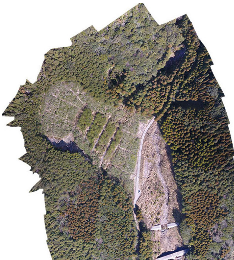
図 3 斜面崩壊地の植生回復状況
