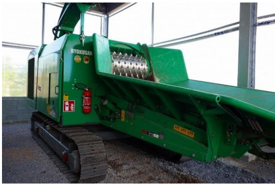
写真 7-2d. 木質チップを製造するチッパー
