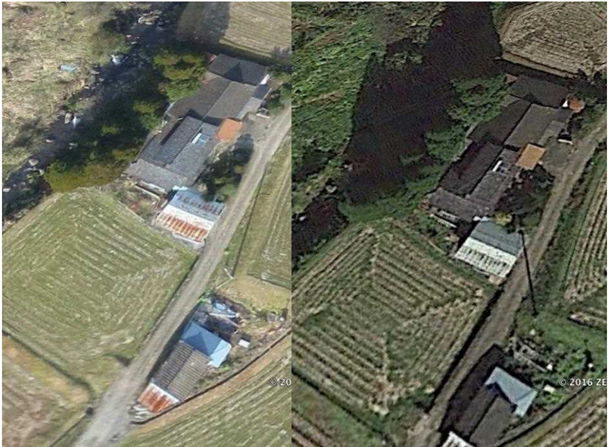
図 53. eBee による空撮画像と Google Earth の衛星画像の比較（ただし、取得した時期は異なる）
