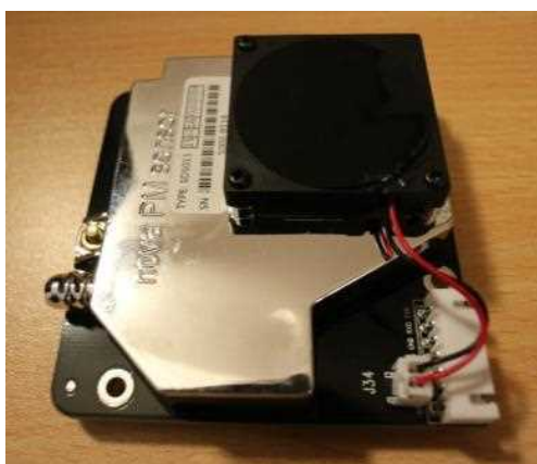
図 28. Nova Fitness 社の PM2.5 センサー-Laser PM2.5 Sensor SDS011
