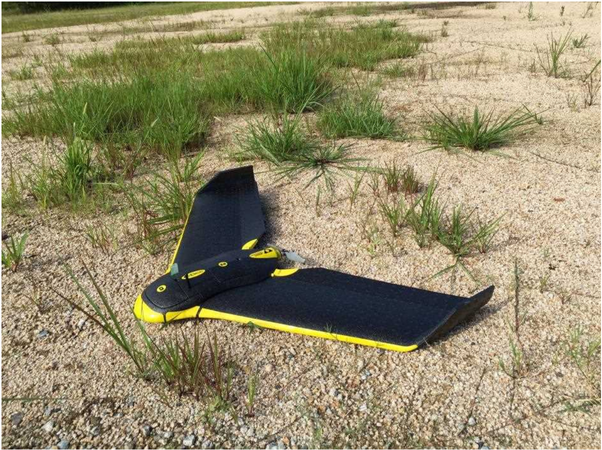
写真 1. 調査に用いた固定翼型のドローン eBee
